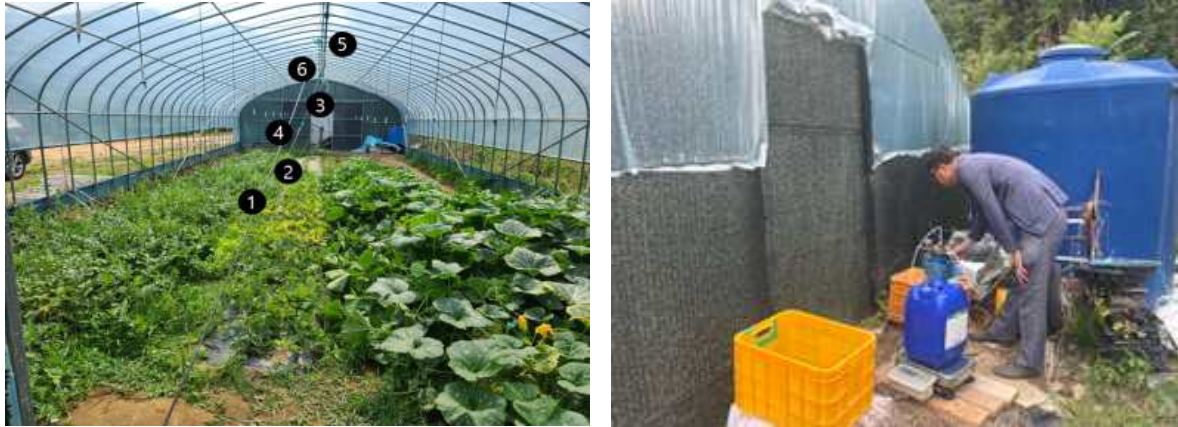
그림 36. 비닐하우스(340 m 3 ) 내 샘플 라인 위치 및 노즐 분사형 EF 훈증 처리
