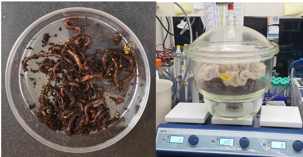
그림 12. 지표생물(지렁이)의 급성 독성 평가를 위한 지렁이 채집 및 12 L 데시케이터를 이용한 EF 훈증 처리 실험 사진
