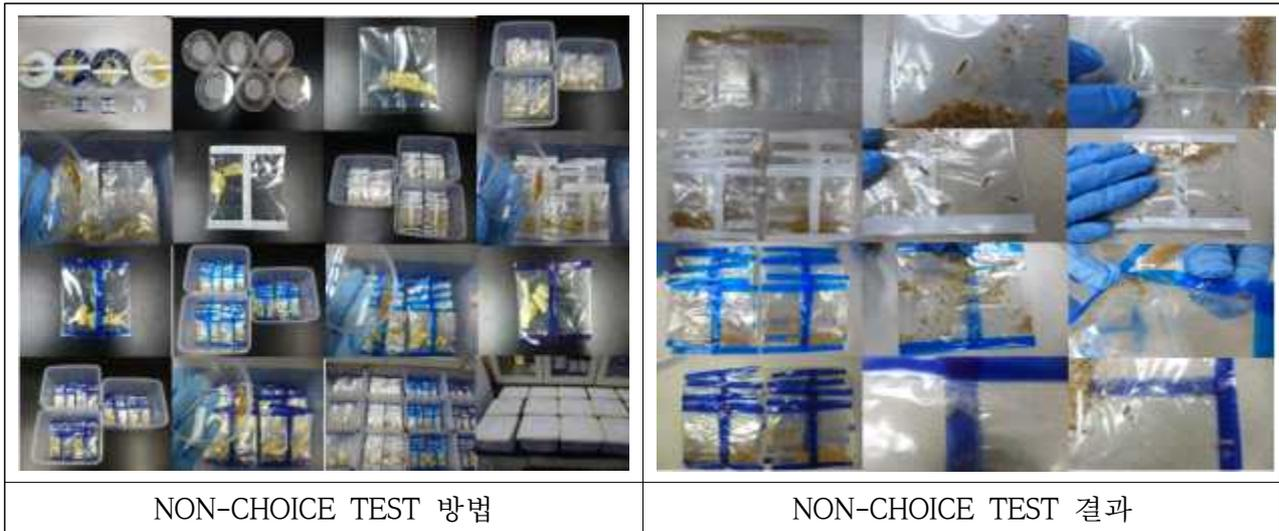
그림 49. 화랑곡나방, 수시렁이 유충의 점착제, 점착제, 점착제+방충물질 적용 다층필름 포장재 방충효과 검증 실험(NO-CHOICE TEST)
