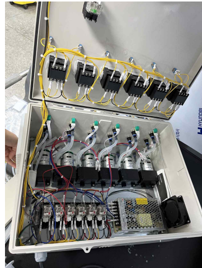
그림 24. 분뇨배양시스템-3(샘플가스 포집 장치)
