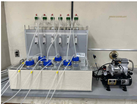
그림 21. 충남대학교 약취 물질 포집용 분뇨배양시스템 모식도 (상) 및 실제 사진 (하)
