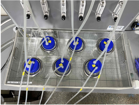
그림 22. 분뇨배양시스템-1(배양수조 및 배양용기)
