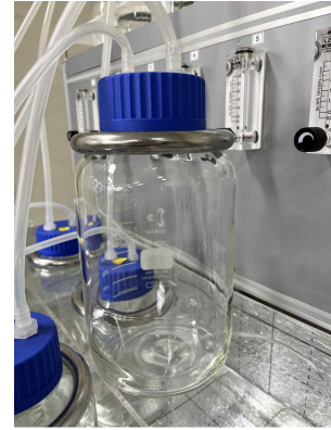
그림 22. 분뇨배양시스템-1(배양수조 및 배양용기)
