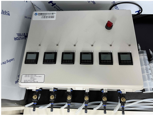
그림 24. 분뇨배양시스템-3(샘플가스 포집 장치)
