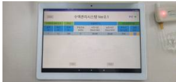
고정 장치의 전원을 켜고, 고무관에 닿았을 때 모듈에서 “정상”이라고 현재 상태를 알려주며, 모듈에서의 상태를 태블릿으로 전송되어 동일한 상태를 어플을 통해 보여줌
