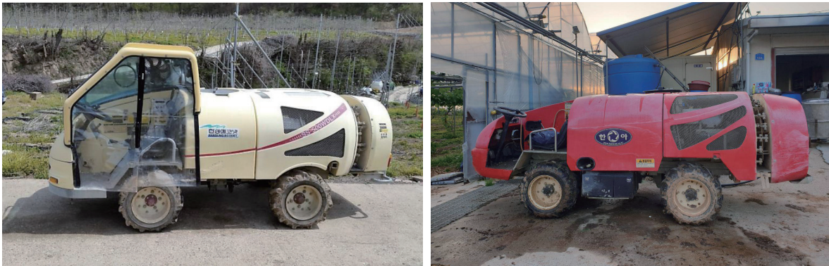
그림 2-6. 캡(cap) 유무에 따른 SS기(Speed Sprayer) 예시
