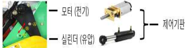
러그 콘베어 상하위치 조정 ※ 유압 사용 시 현재 유압실린더 사용하니 그 동력 가져와 사용함
