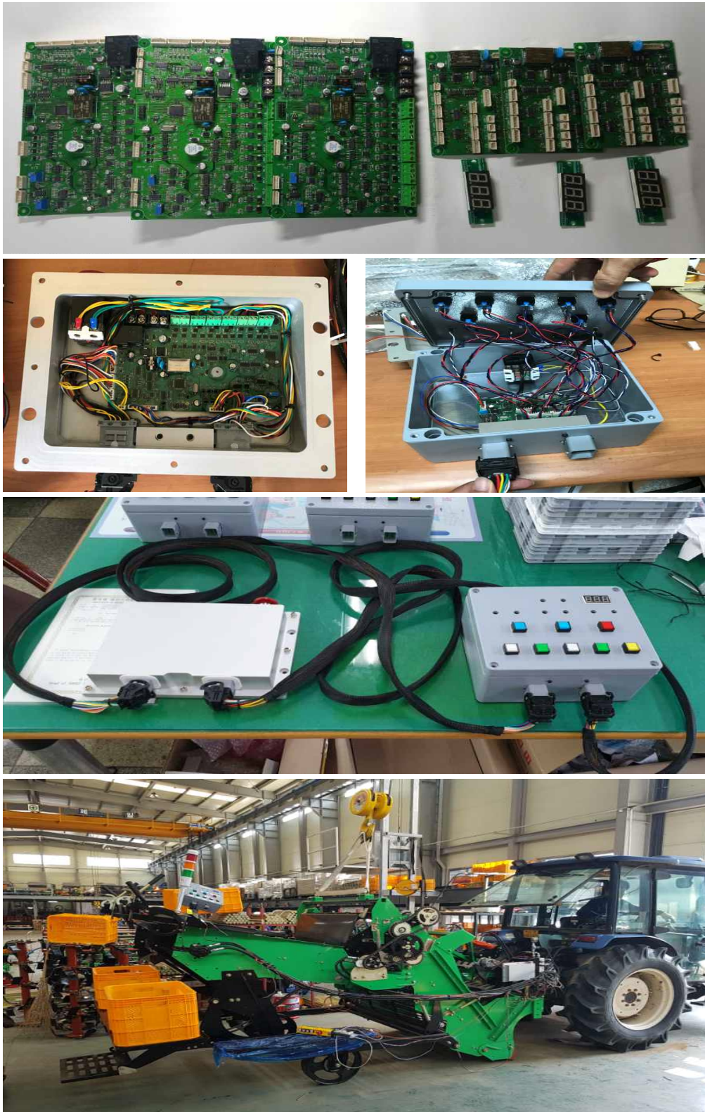
[ 제어부인 메인회로와 통합 컨트롤러 제작 후 실차 장착 모습 ]
