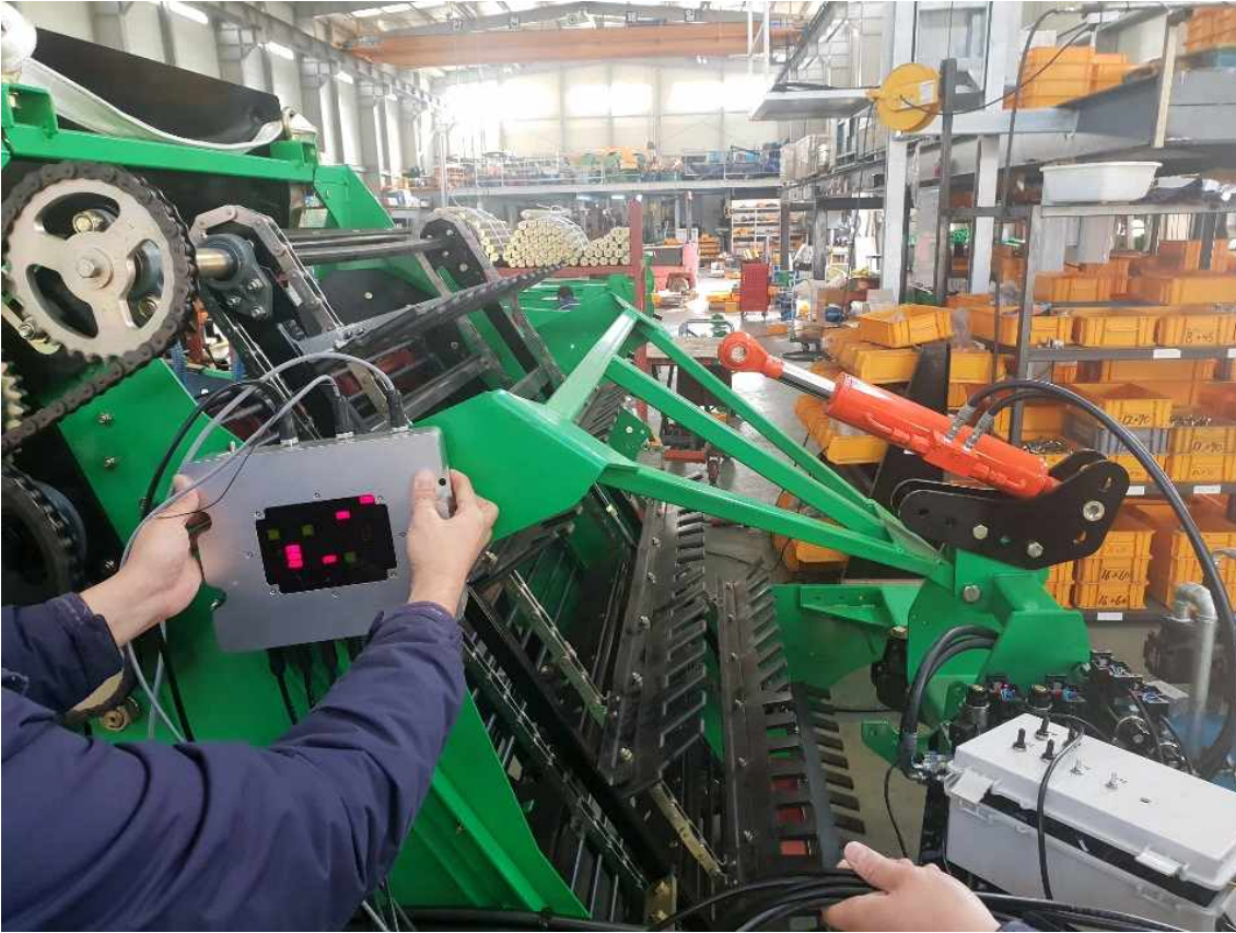
[ 실제 케이스와 수확기를 연결하여 버튼으로 굴취 속도와 선별부 속도를 제어하는 모습 ]
