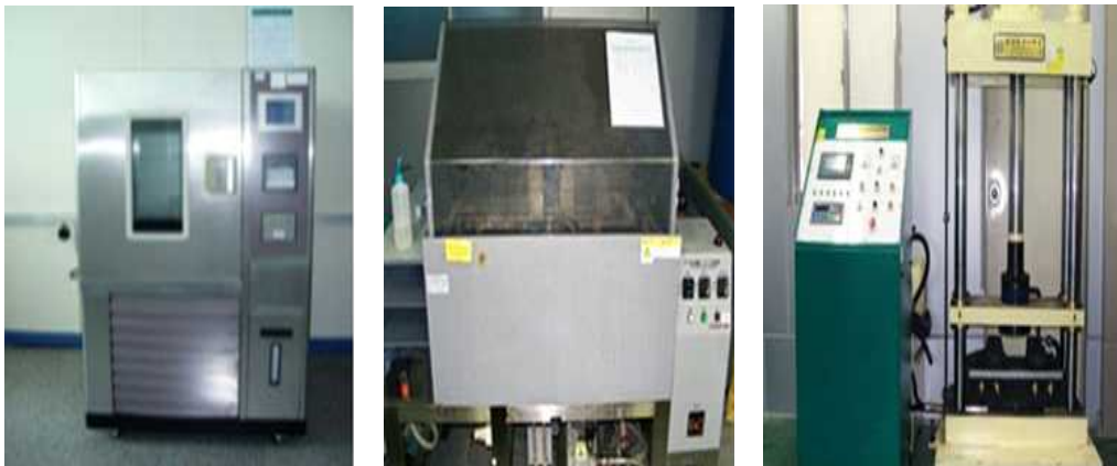
- KCL 시험기관에서 3가지 챔버 시험(항온항습, 염수분무, 진동) 진행 - [ 1차년도 문제점들을 보완하는 개선 사항들을 2차년도 전장부에 반영 ]
