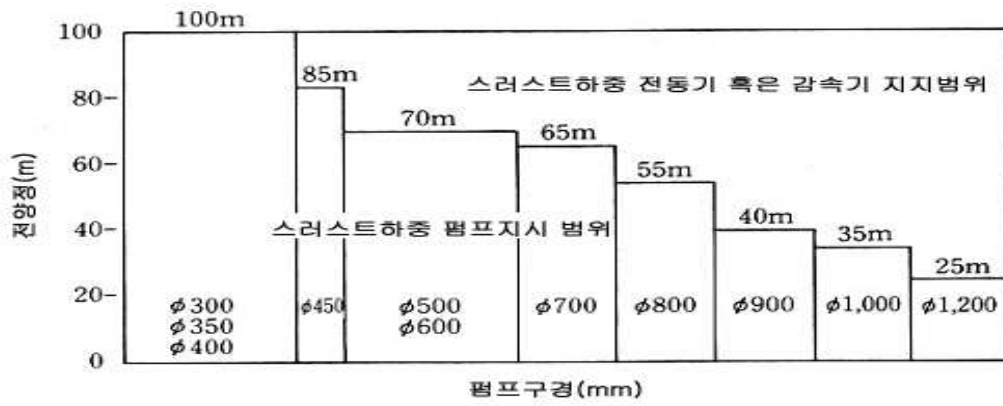
그림 4 참고 14 입축 편흡입 볼류트펌프 스러스트 하중지지범위도
