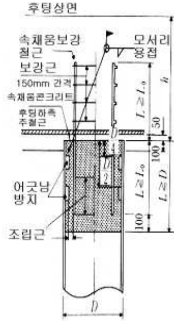
그림 4.2.20 프레스트레스트 말뚝인 경우 B
