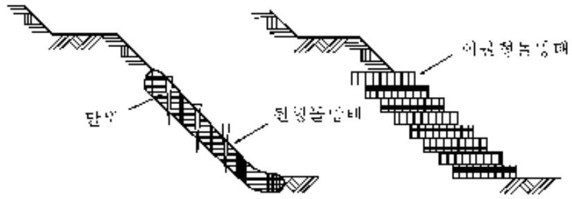
그림 4.10.7 원형 돌망태공, 이불형 돌망태공의 사용 예
