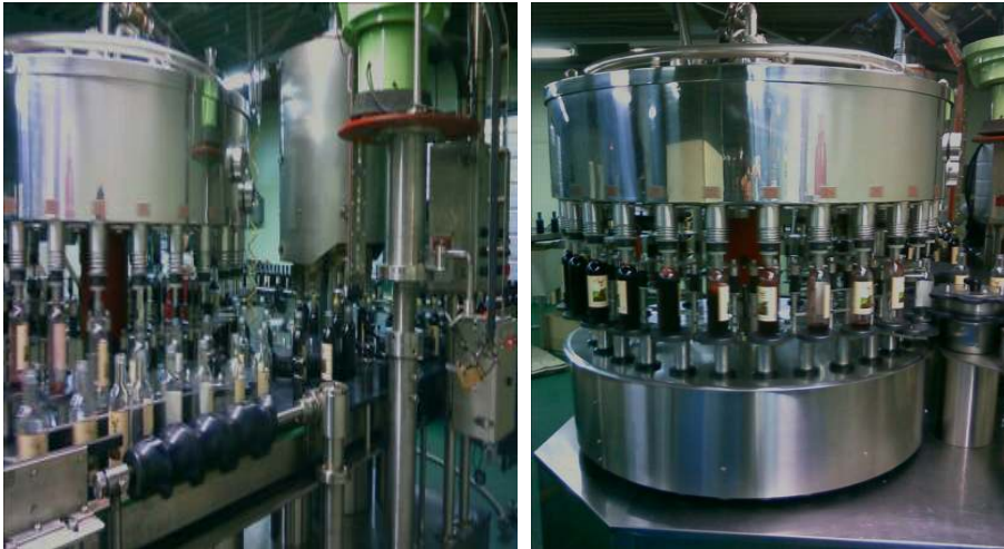
Fig. 16. 충전기 병입부분(좌), 충전기 술 주입 부분(우)
