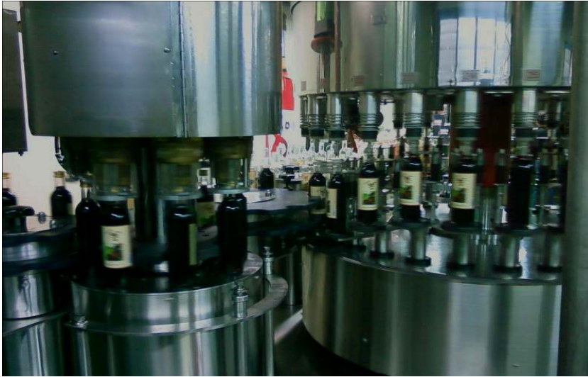
Fig. 17 충전기에서 술 주입 후 병 마개 sealing 부분
