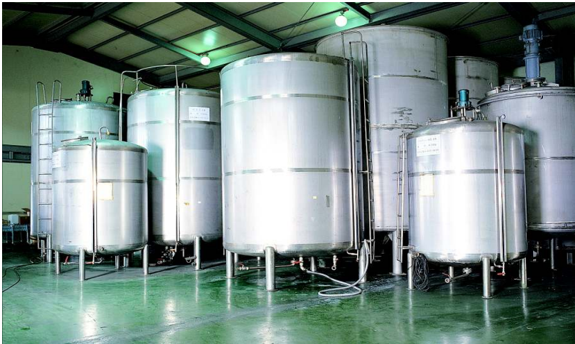
Fig. 7. 탱크 현황 사진 - 발효탱크, 저장탱크, 숙성탱크
