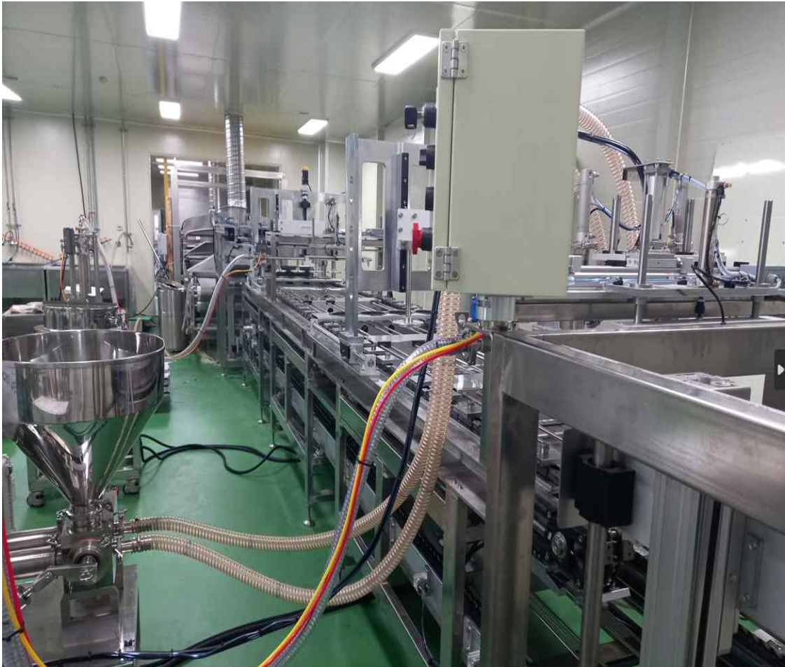
[그림44] 전 생산 자동화 설비 제작 및 설치
