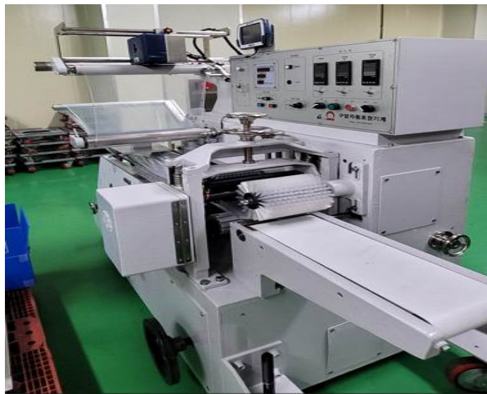
그림 41) 필로우포장기 제작 및 설치
