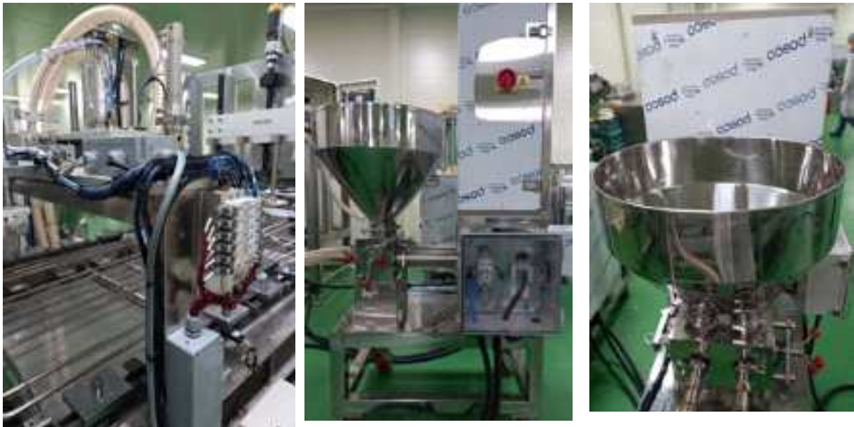
그림 25) 내용물 공급 Unit 제작 및 설치
