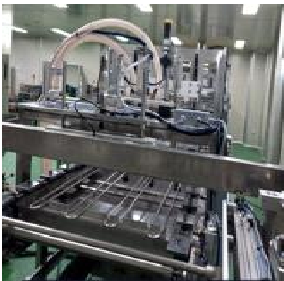
그림 21) 틀이송체인 CONVEYER 3 Unit 제작 및 설치
