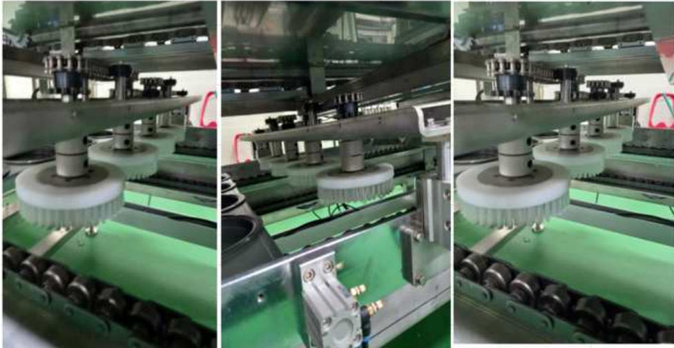
그림 35) BRUSH Unit 제작 및 설치
