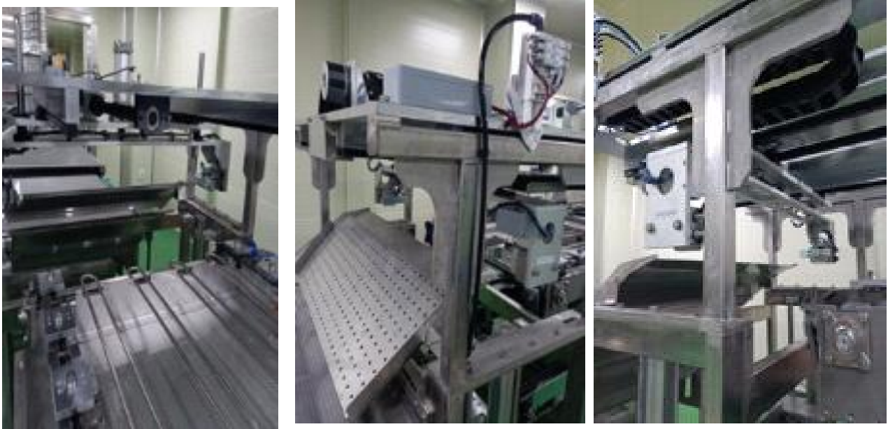
그림 31) LOADING LIFT Unit 제작 및 설치
