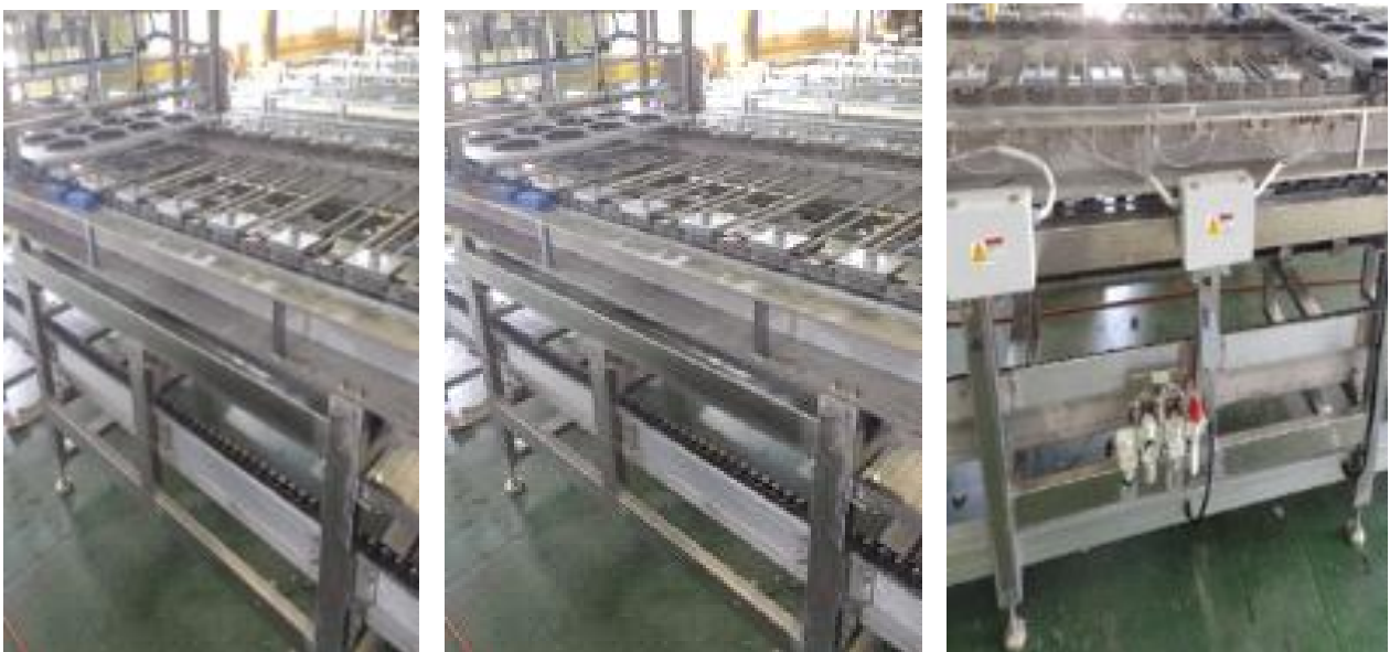
그림 20) 틀이송체인 CONVEYER 2 Unit 제작 및 설치
