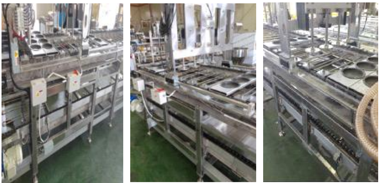
그림 18) 틀이송체인 CONVEYER 1 Unit 제작 및 설치
