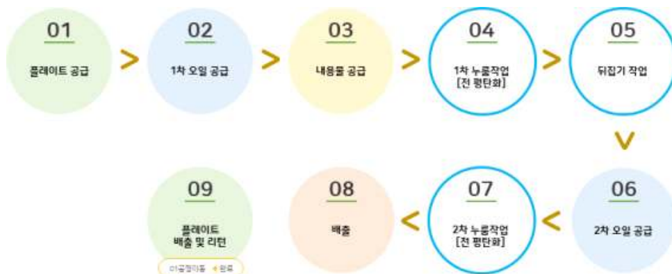
[그림43] 전 생산 자동화 설비 전제 공정도
