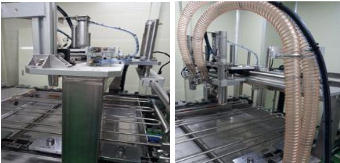
그림 27) 오일 공급 #1, #2 Unit 제작 및 설치
