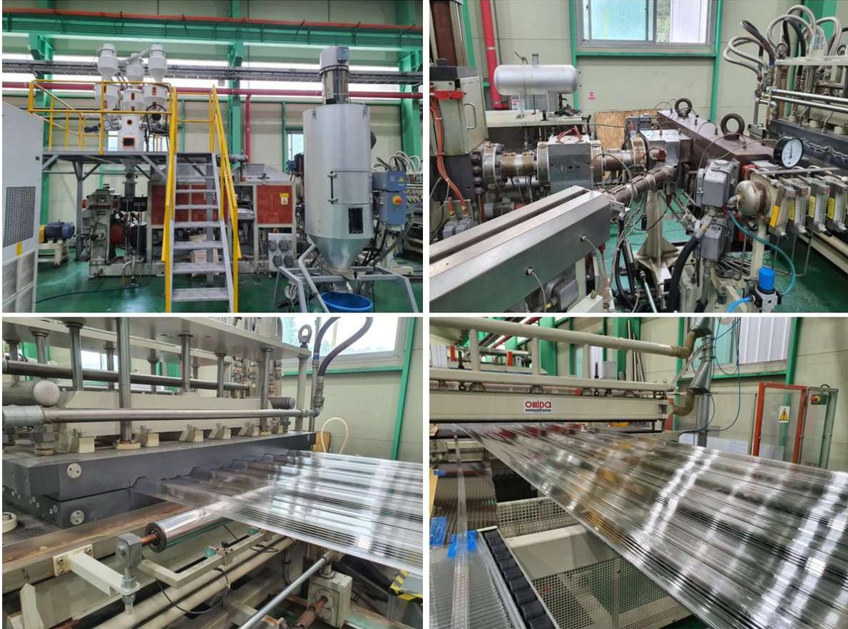
그림 2-13. S-Polytech 복층골판 sheet 압출기
