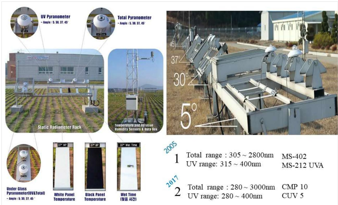
그림 2-31. 기상환경인자모니터링 시스템(서산 옥외폭로시험장)
