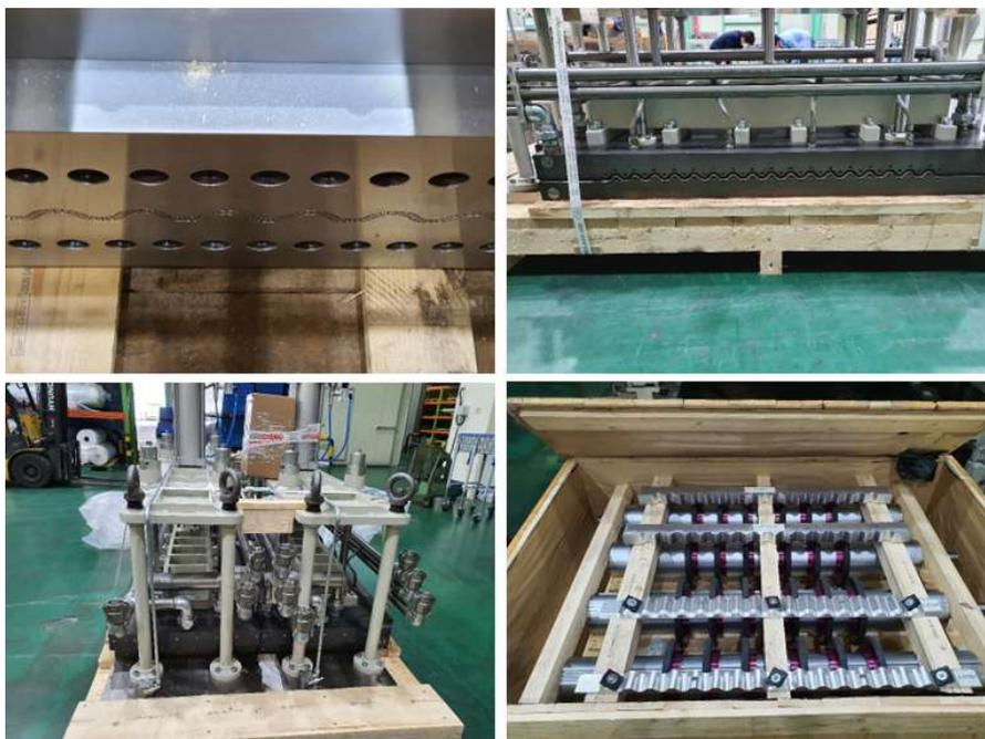
그림 2-26. 신규 복층골판 C-63 생산을 위한 T-die 및 부대설비
