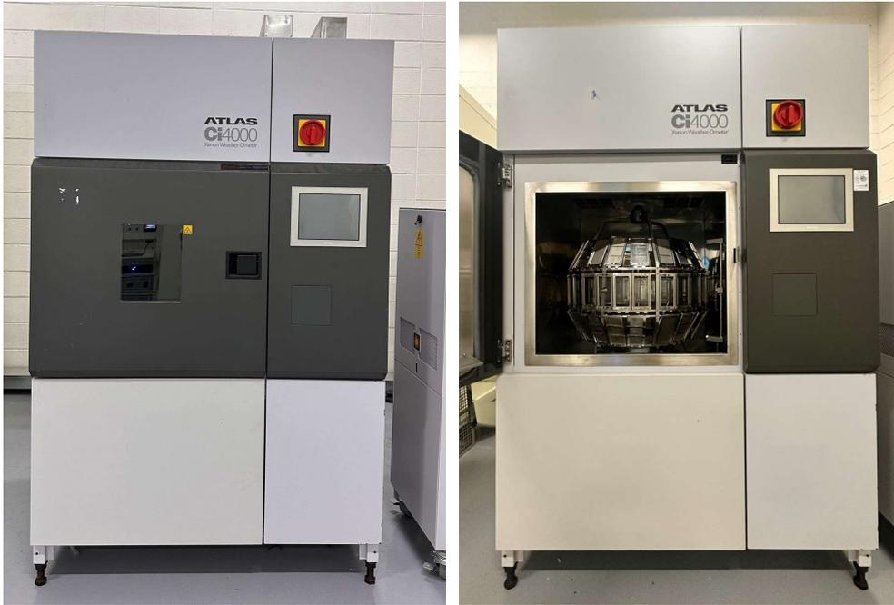
그림 2-46. 실내축진시험(Xe) - 진천 site
