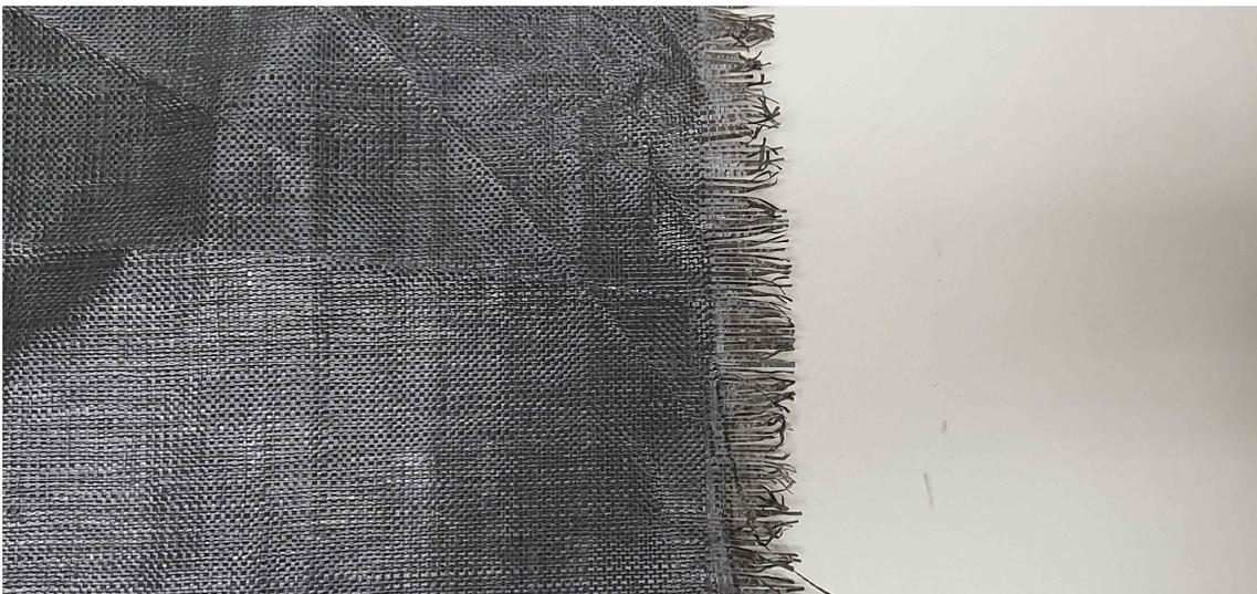
Fig 56. Selvage Tension에 의한 변사 빠짐 현상 발생
