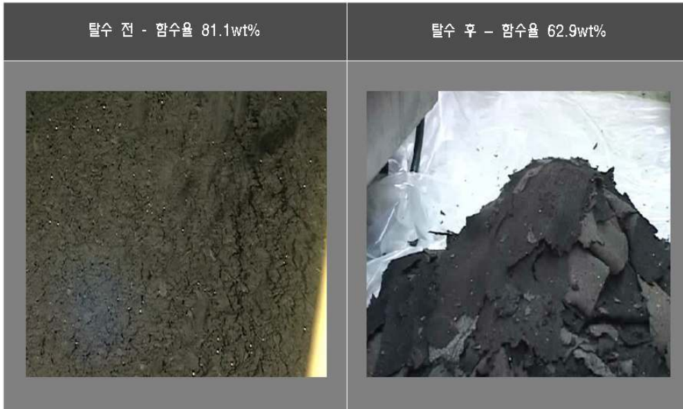
그림 3-4. Belt Press와 전기침투탈수기의 탈수슬러지 비교
