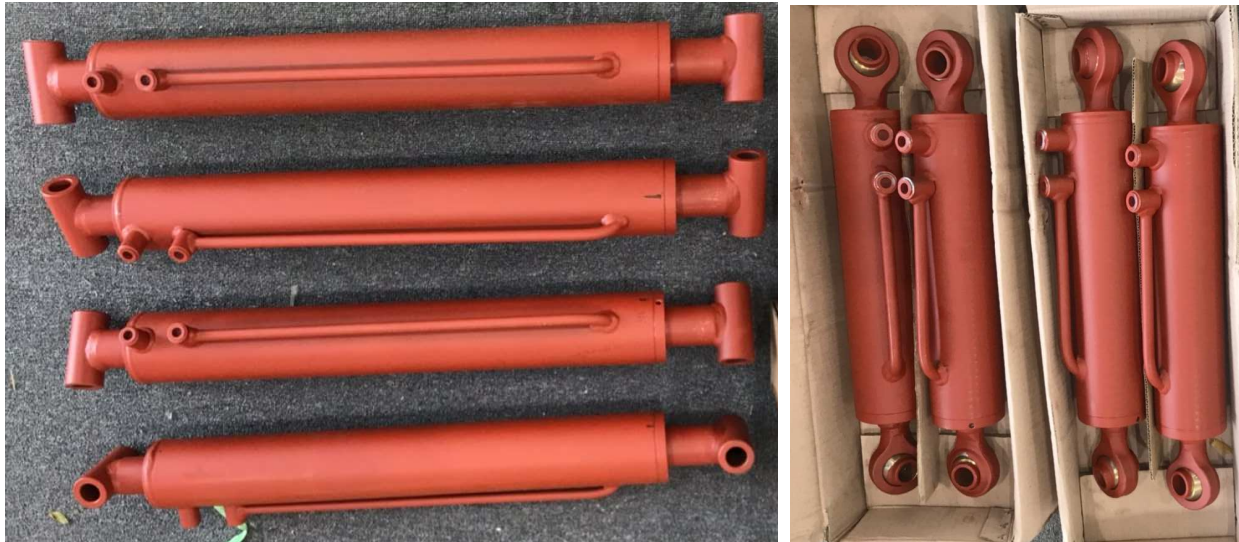
[날개접이 실린더(좌) 및 높이&수평제어 실린더(우) 제작 사진]
