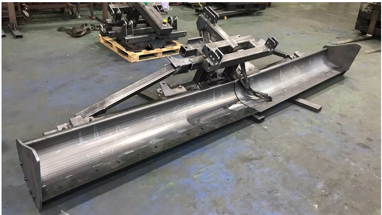
[레이저 균평기 시제품 TYPE_A 제작 사진]
