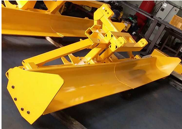
[레이저 균평기 시제품 TYPE_A 도장 완료 사진]
