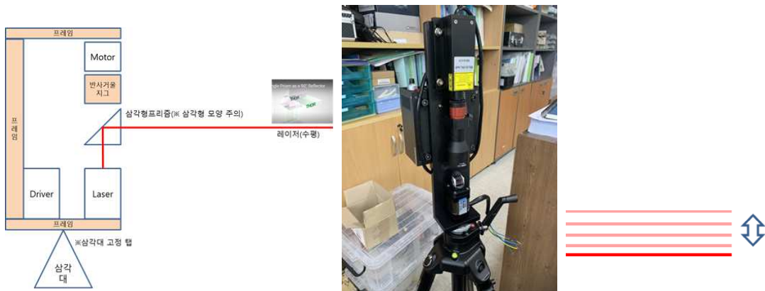
[시험용 레이저 송신기 설계 및 제작]
