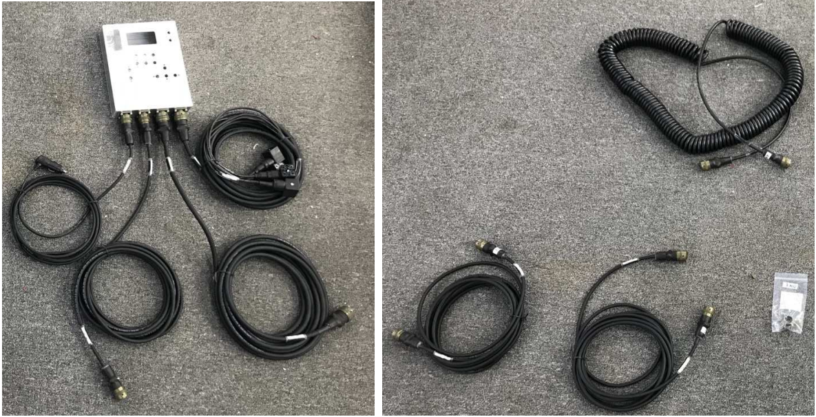
[컨트롤러에 통신선 및 사각 커넥터(상대물) 연결 사진]
