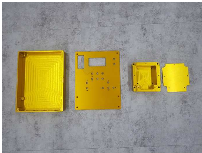
[컨트롤러 2차 케이스, IMU 케이스 시제품]
