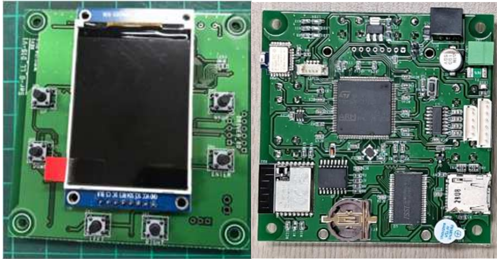
[개발 송신기 PANEL PCB 사진(좌:앞면, 우:뒷면)]
