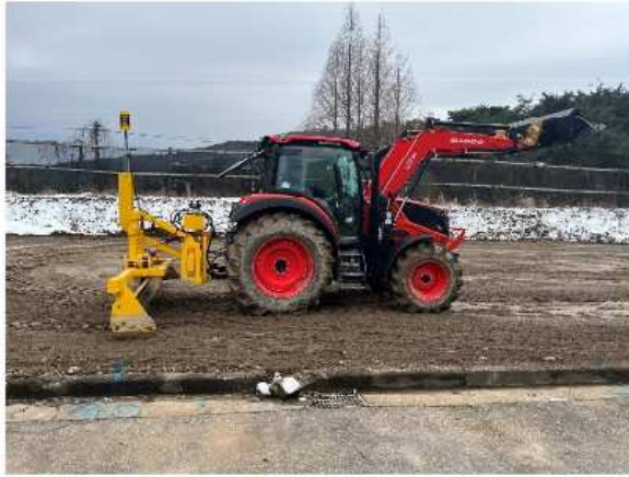
사진 1. 레이저수신기, IMU 센서, 컨트롤러 (트랙터 부착)
