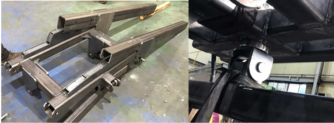
[레이저 균평기 시제품 TYPE_B 제작 사진]
