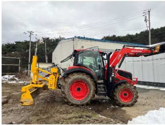
사진 4. 레이저수신기, IMU 센서, 컨트롤러 (트랙터 부착)
