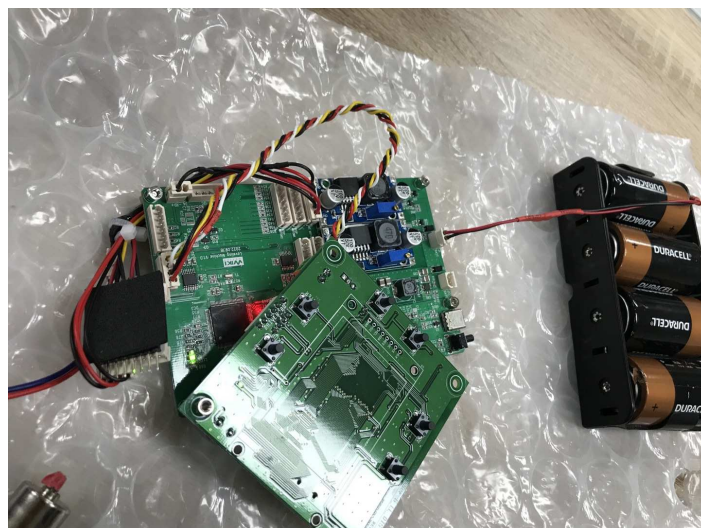
[(위키옵틱스 제공)송신기 테스트용 구동부 PCB]
