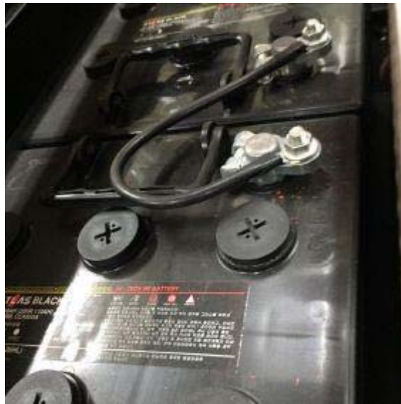
그림 855 두 대의 12V 배터리 연결
