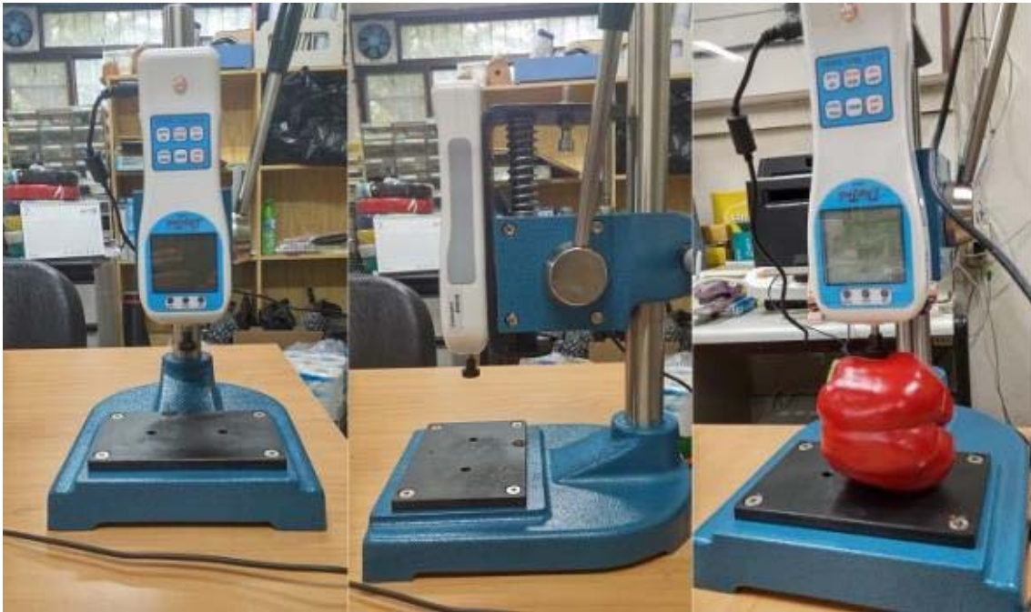
그림 342 push-pull gauge를 이용한 압축강도 측정
