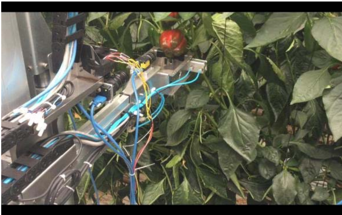
그림 989 Failed harvesting scene due to thickness of guide.
