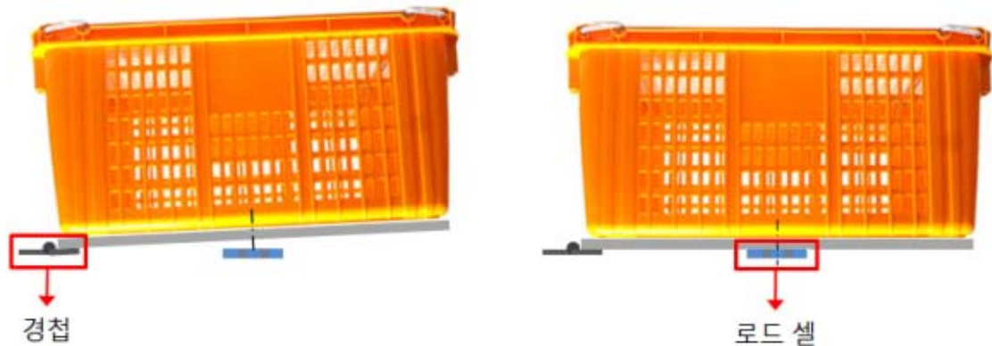
그림 912 무게 획득 장치 기초 설계
