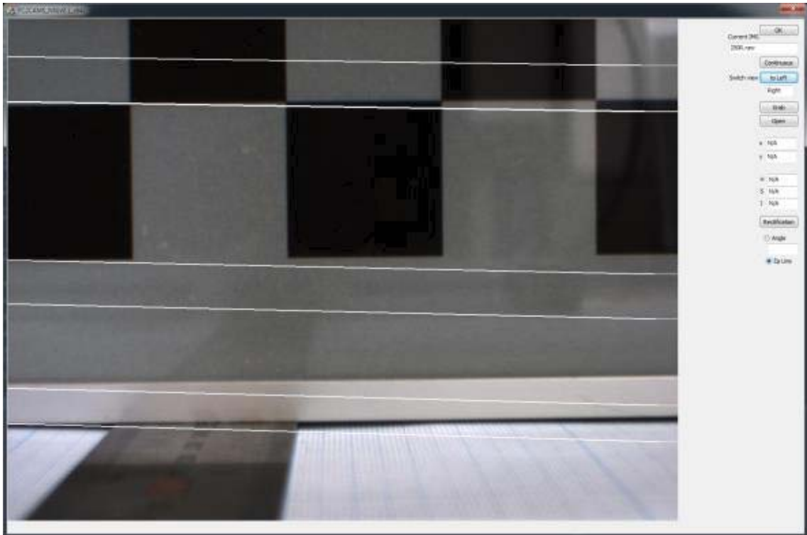
그림 644 계산된 F 행렬을 이용하여 계산된 에피폴라 라인
