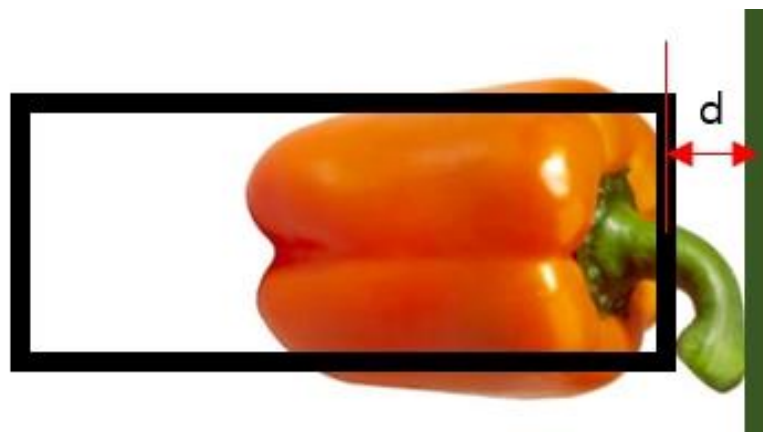
그림 990 Distance between end-effector and stem.
