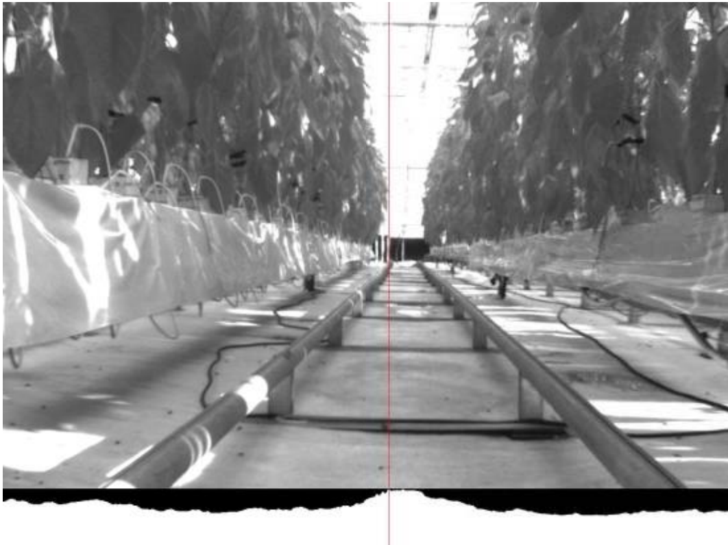
그림 884 명도 히스토그램을 이용한 NIR 영상 레일 중심 추출 결과 670nm
