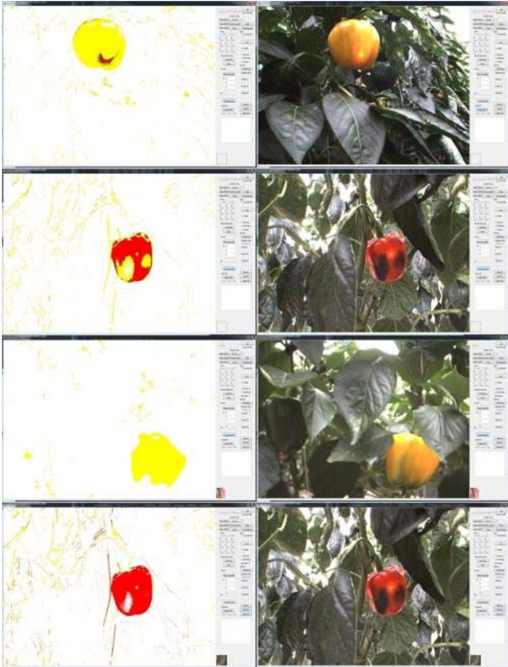
그림 754 Activation images using Deep neural network.
