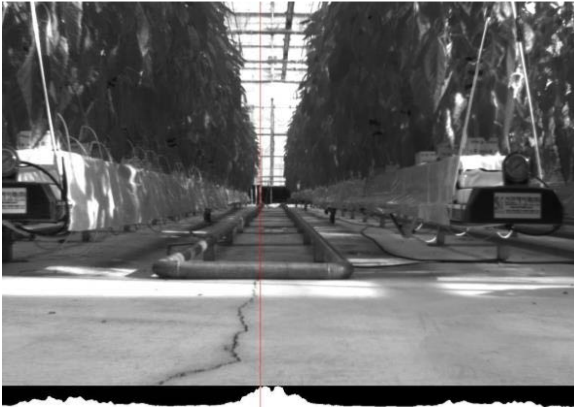
그림 886 명도 히스토그램을 이용한 NIR 영상 레일 중심 추출 결과 769nm
