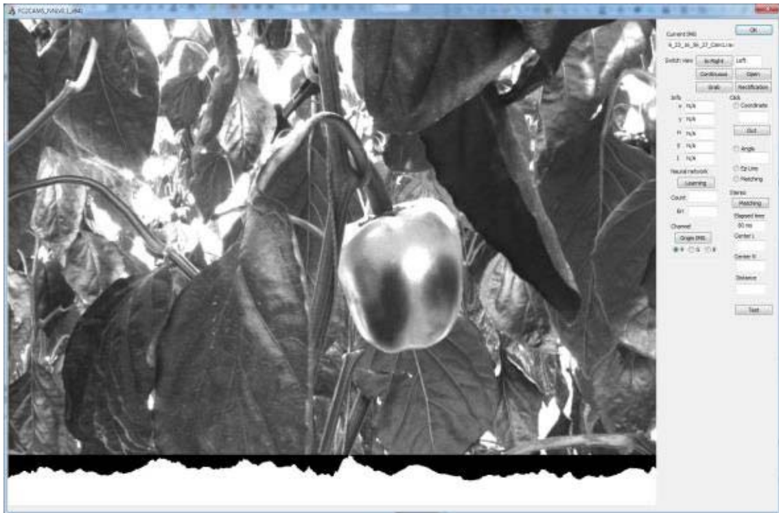
그림 640 입력 영상의 R 채널 영상 및 히스토그램
