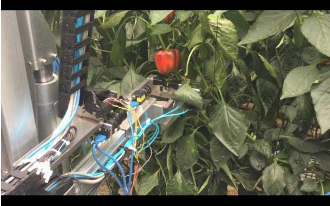
그림 991 Failed harvesting scene due to edge of end-effector.
