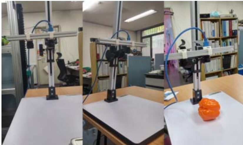
그림 24 BFLY-U3-13S2C-CS을 사용한 파프리카의 스캔
