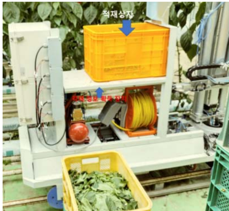
그림 925 적재 정보 획득 장치를 추가한 파프리카 수확기 주행 시스템
