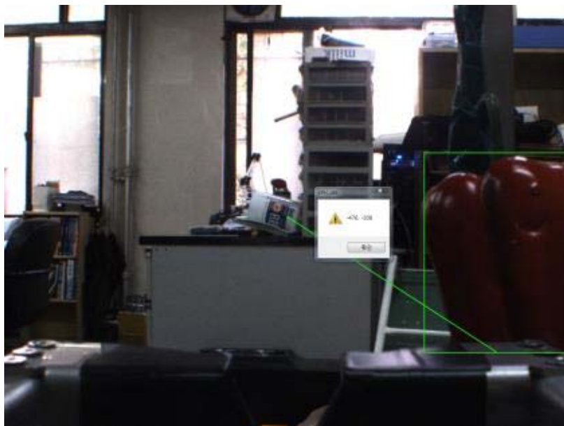
그림 982 Test of sweet-pepper's position controlling using image(1).
