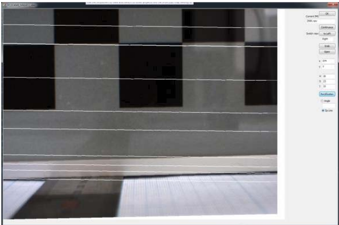
그림 649 에피폴라 선을 평행하게 변환 후 보관한 영상
