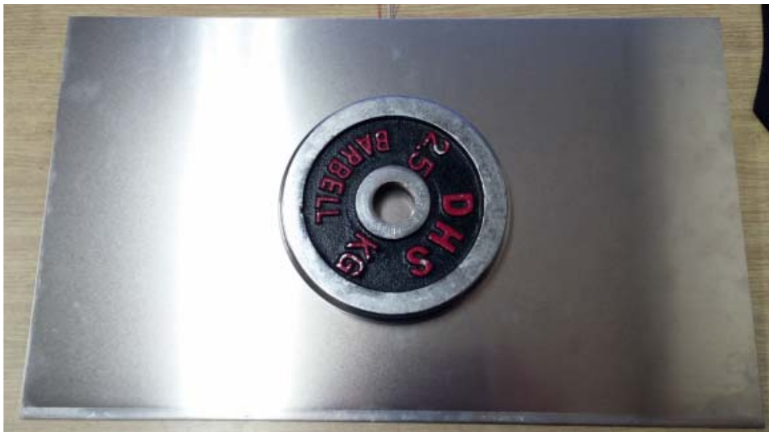
그림 916 무게 정보 획득을 위해 중량물을 패널위에 위치한 모습
