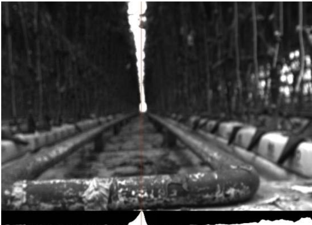
그림 882 R채널 히스토그램을 이용한 컬러 영상 레일 중심 추출 결과 #1
