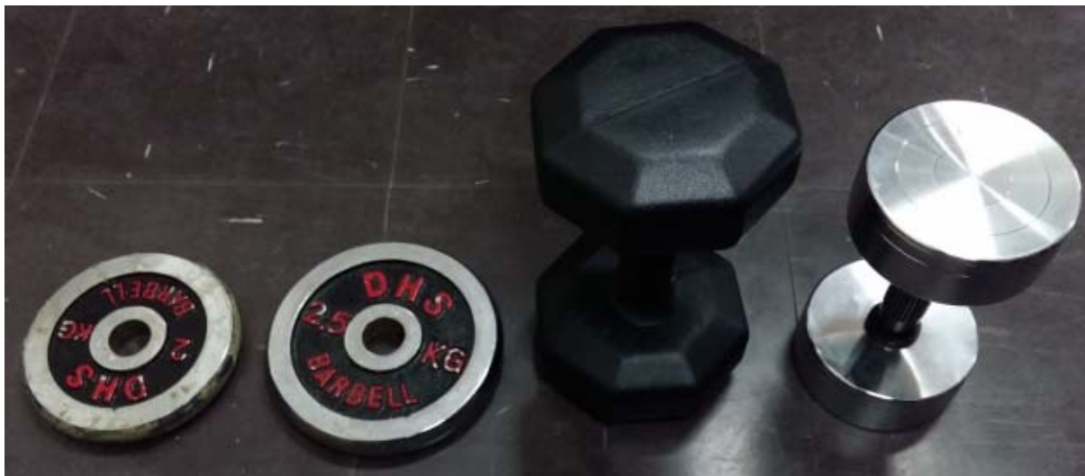
그림 914 로드 셀 캘리브레이션을 위한 중량물(2kg, 2.5kg, 5kg, 7kg)
