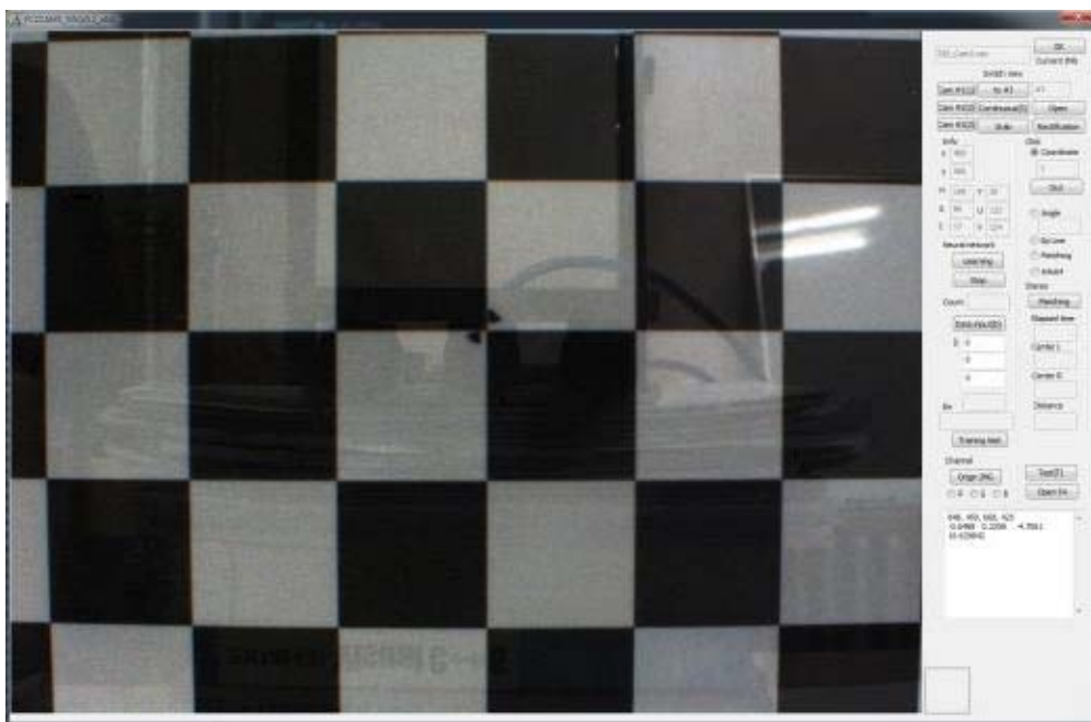
그림 805 Calibration board image(Z distance : 250mm).
