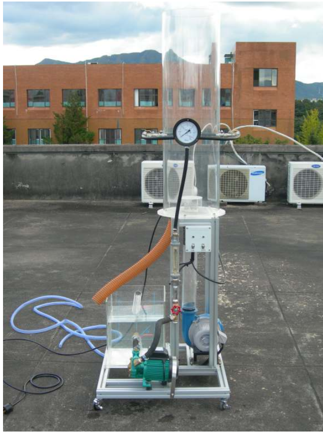
그림 22. 제작된 실험용 수압 분무식 분진 제거장치
