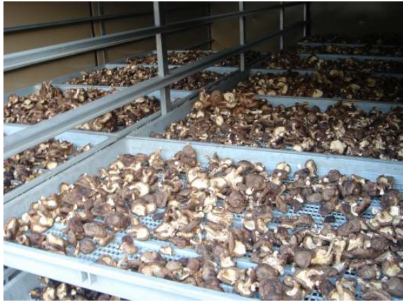
그림 19. 폐열에너지 건조기를 활용한 고추, 표고 등의 농산물 건조 모습
