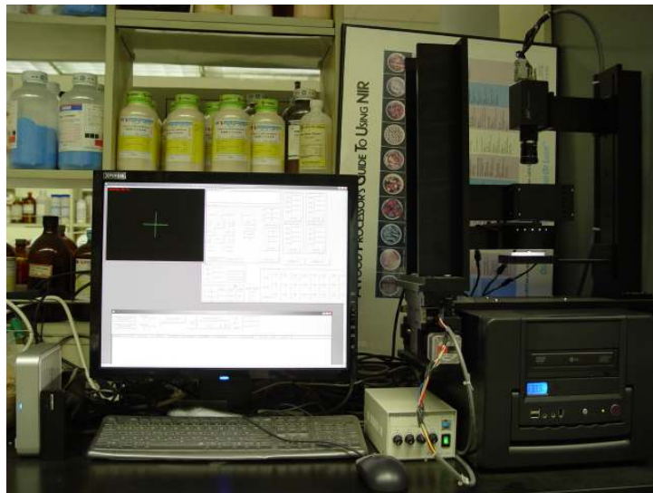
그림 3-2-35. 외형인자 측정시스템 시작기
