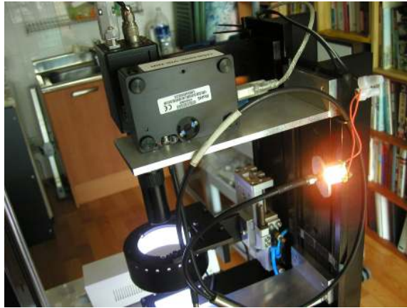
그림 3-4-7. 시스템 제작(영상획득부 및 Spectrometer 처리부)
