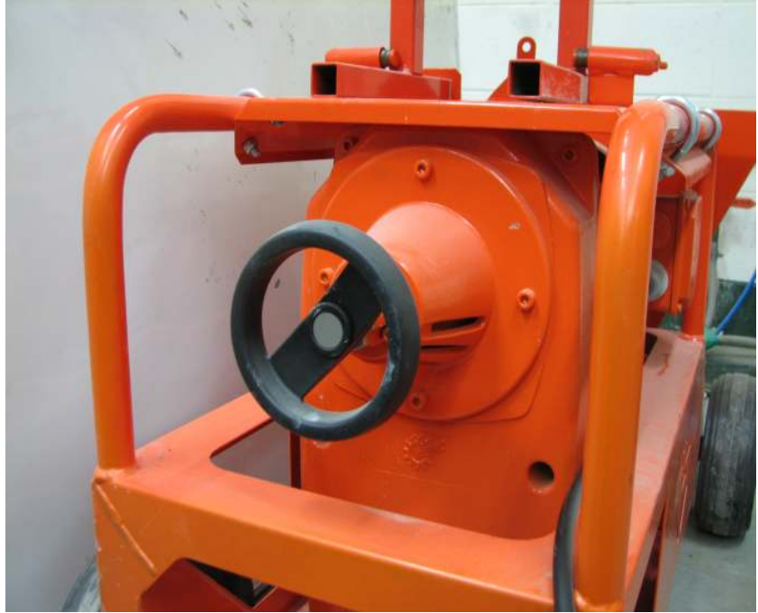
(a) 스프레이 장비에 설치된 펌프의 정면모습
