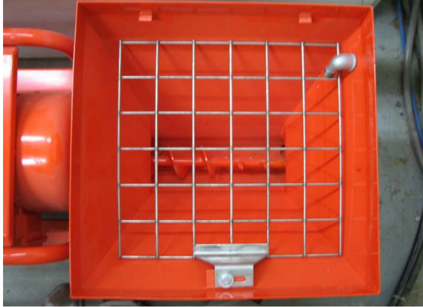
<그림 3.46> 스프레이 장비에 설치된 자체 믹서
