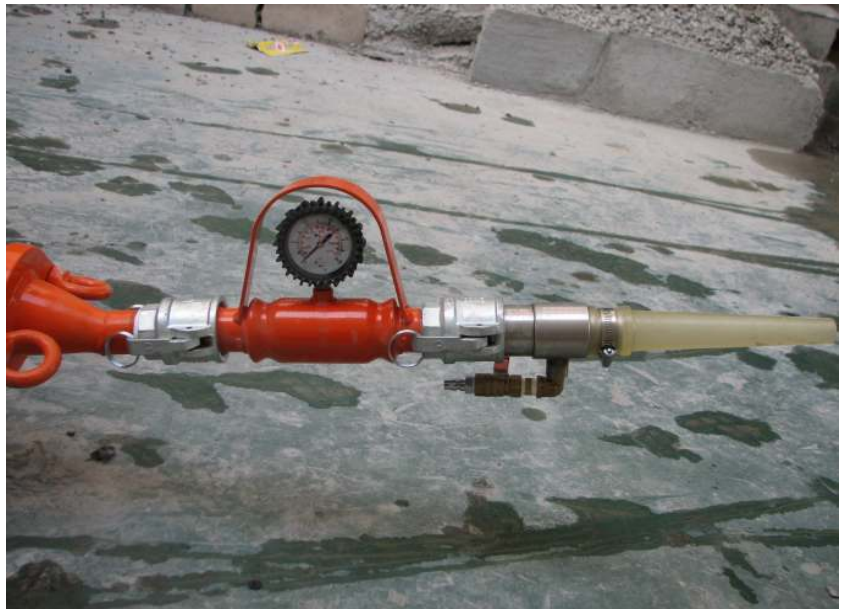
(b) 토출구에 설치된 압력게이지
