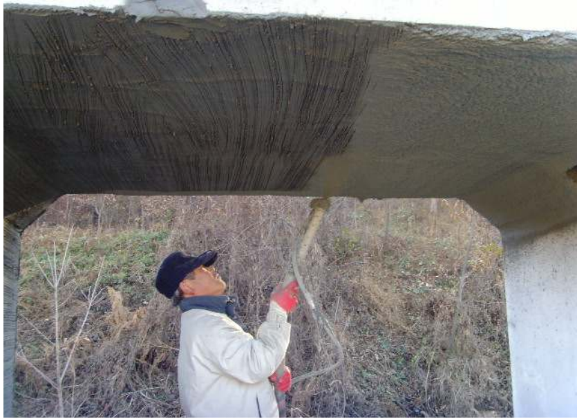
<그림 3.64> 스프레이 타설장비를 이용한 현장Mock-up 시험 모습
