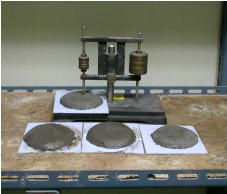
<그림 3.1> 응결시간 시험
