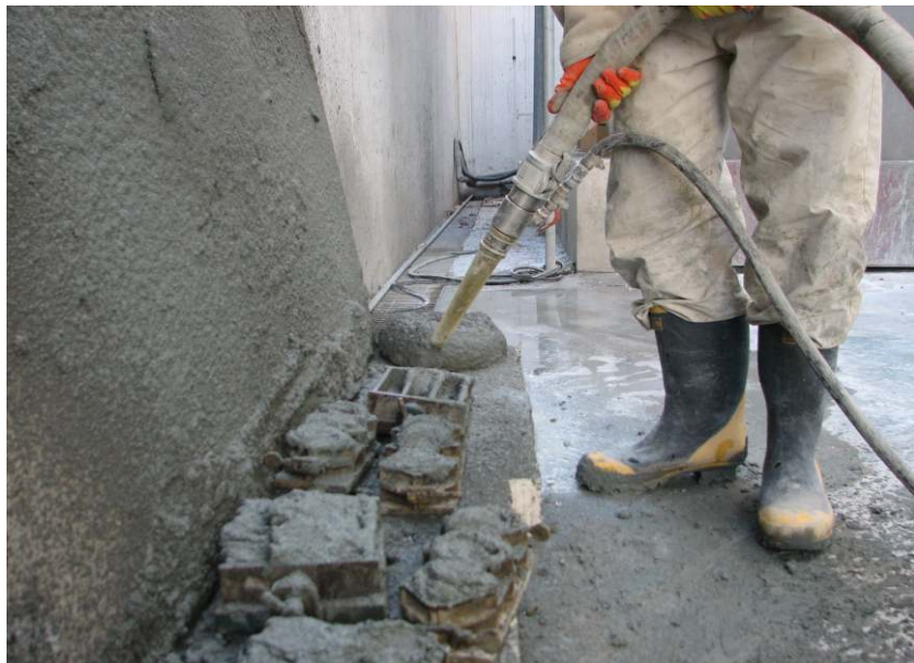
<그림 3.51> 강도시험용 공시체 제작모습
