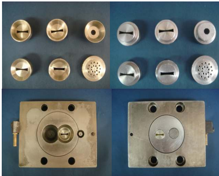
그림 6. Lab 규모 Insert Die
