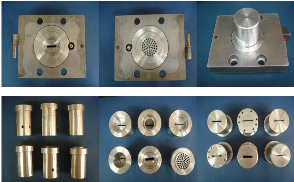
그림 7. Pilot 규모(시간당 35kg 생산) 의 Insert Die 및 압력조절을 위한 Breaker
