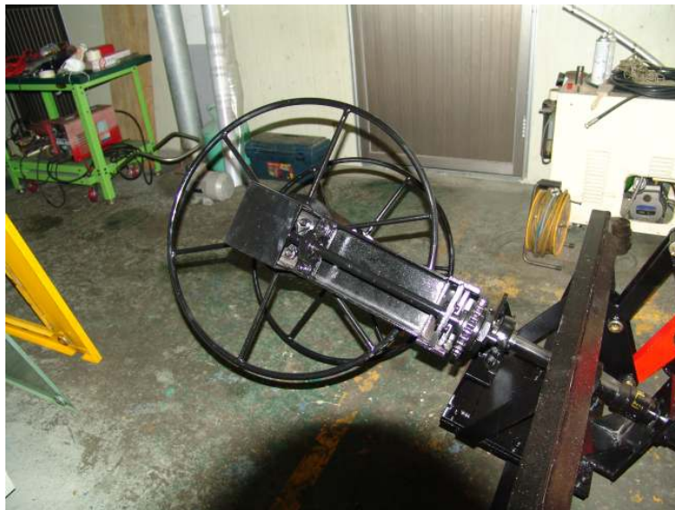
그림 49 부착기형 수거휠 및 동력전달장치 메카니즘 실험
