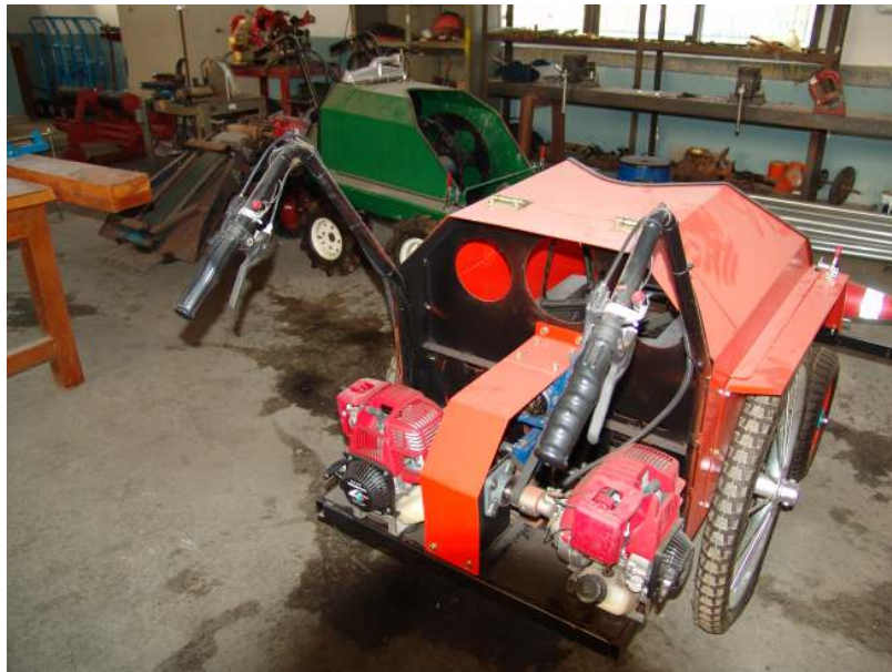
그림 31 개발된 트위스트 휠 방식 비닐 수거 시작기 외형(후면)
