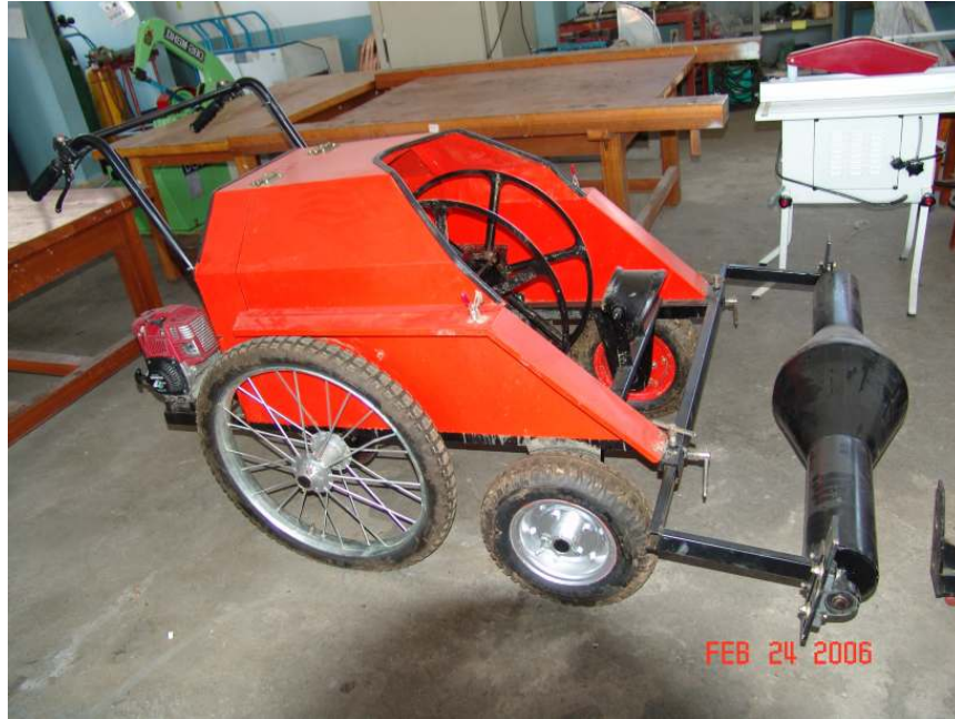
그림 28. 개발된 트위스트 휠 방식 비닐 수거 시험기 외형.
