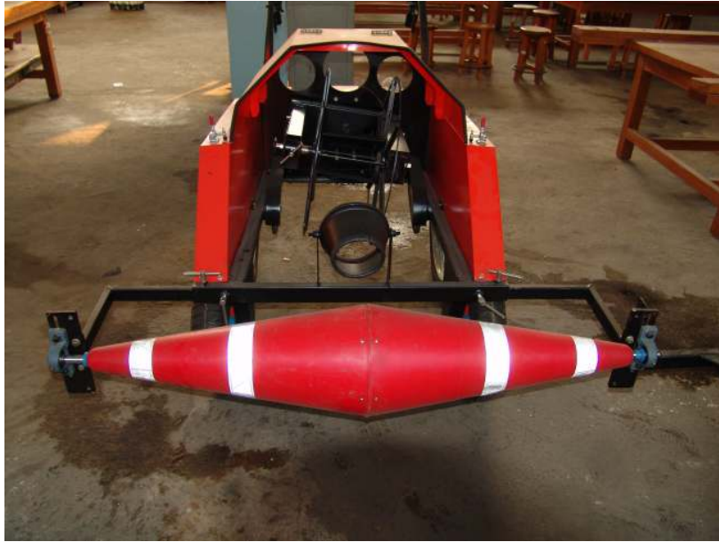
그림 30 개발된 트위스트 휠 방식 비닐 수거 시작기 외형(전면)
