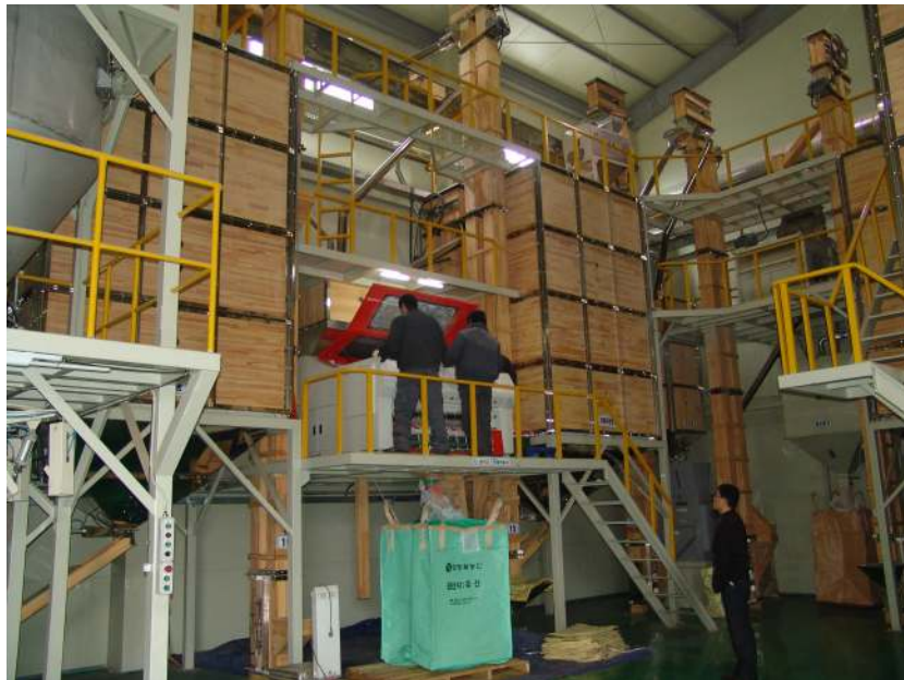
그림 51 설치된 콩 색채선별기 시작기
