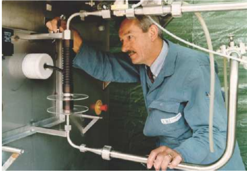
<그림 2-36> Pilot-scale pulsed electric field unit
