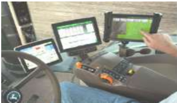
정밀농업장치를 탑재한 농기계 내부 모습
