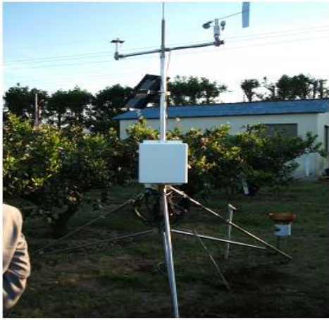
Fig. 1. 감귤연구센터 시험포장에 신규로 설치된 무인기상관측기(AWS)
