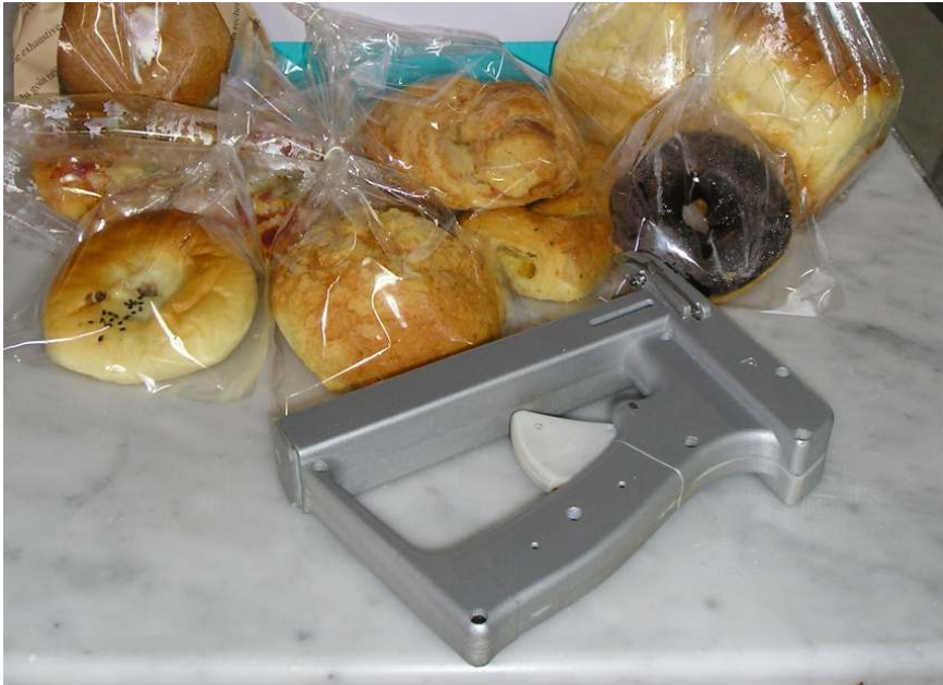
그림 61. 결속성능 시험에 사용된 재료와 결속기(IV)-동우대학
