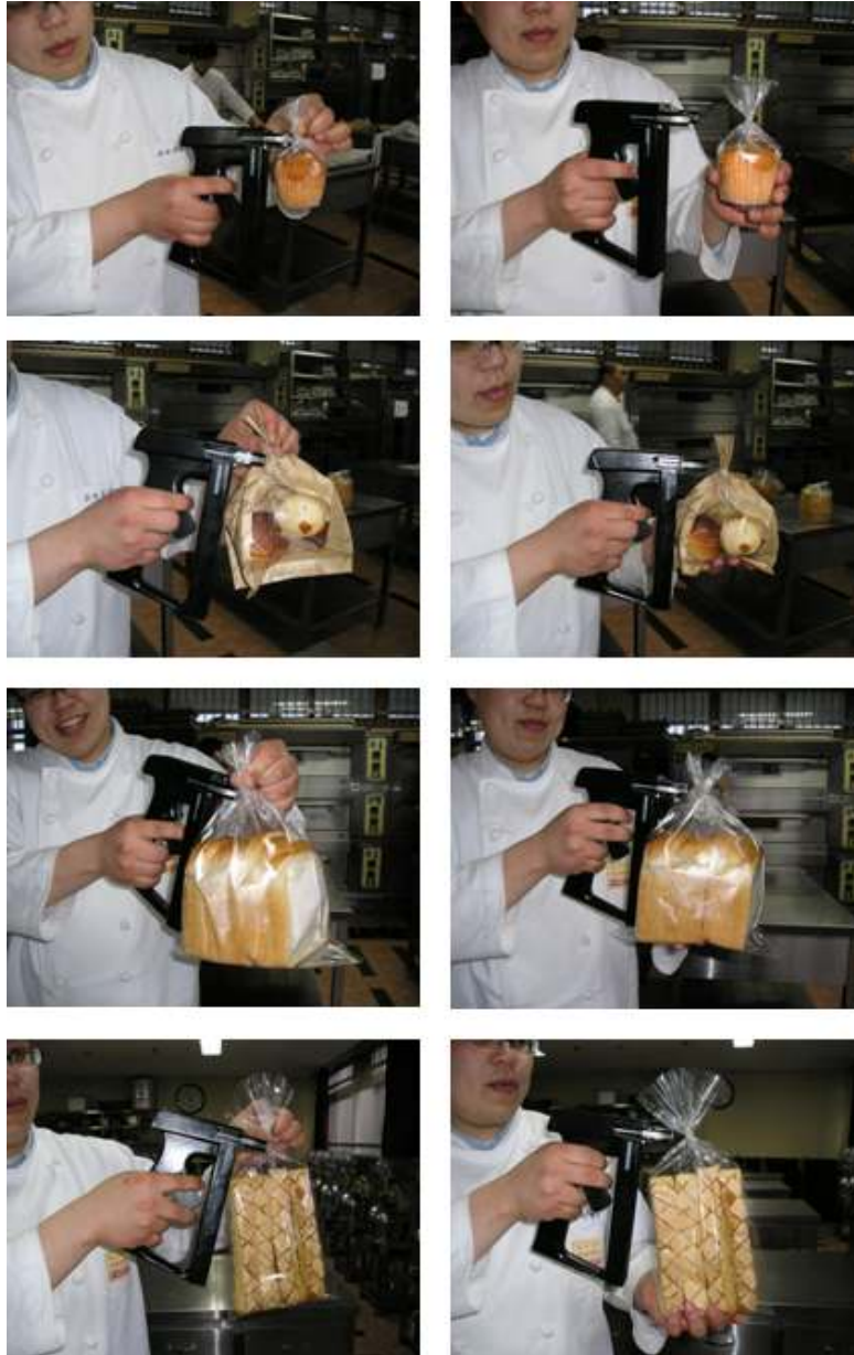
그림 59. 제과제빵 포장봉지의 결속성능 예비시험(1)
