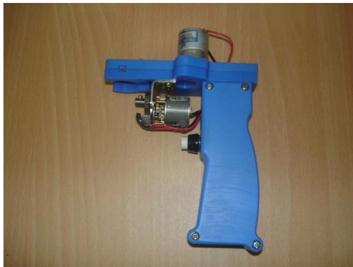
그림 21. 1차년도에 제작된 자동 결속장치에 대한 시작품
