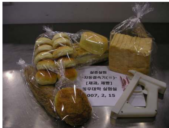
그림 51. 결속성능 예비시험에 사용된 재료와 결속기(Ⅲ)
