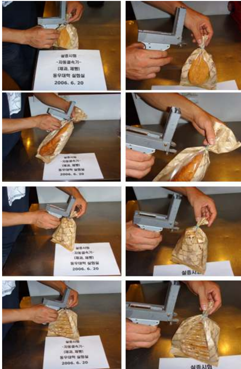
그림 50. 제과제빵 포장봉지의 결속성능 예비시험Ⅱ
