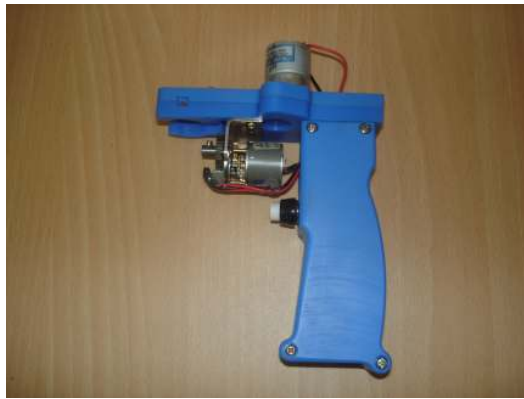
그림 8. 전동 모터가 부착된 휴대용 자동결속기
