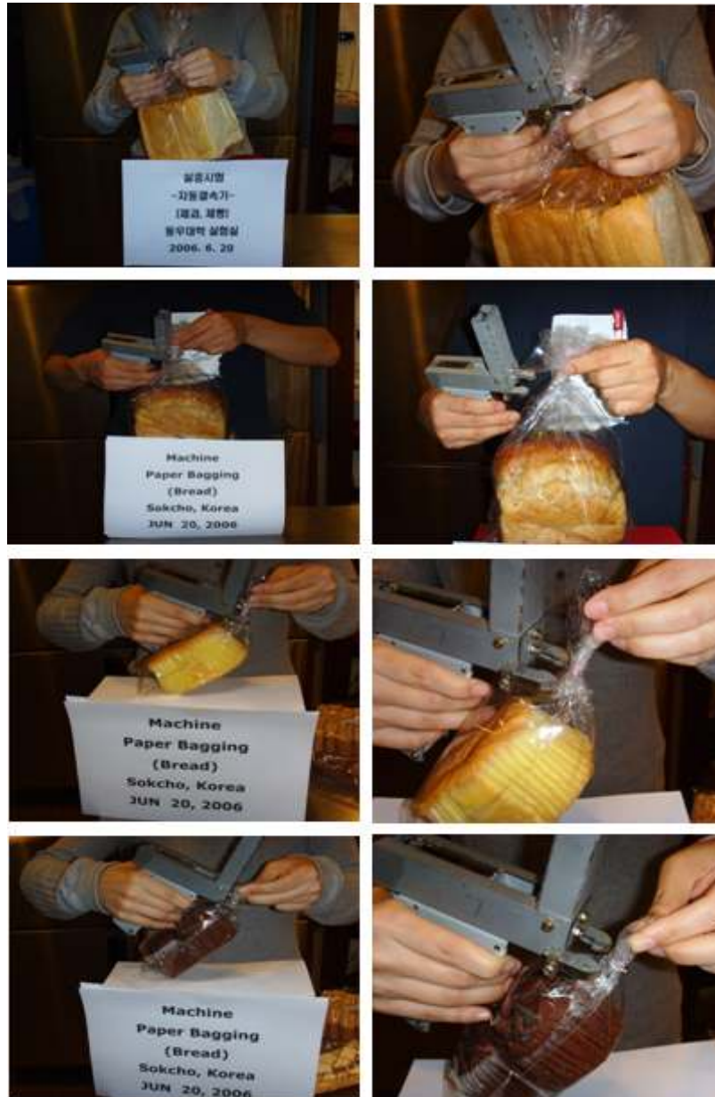
그림 49. 제과제빵 포장봉지의 결속성능 예비시험 I
