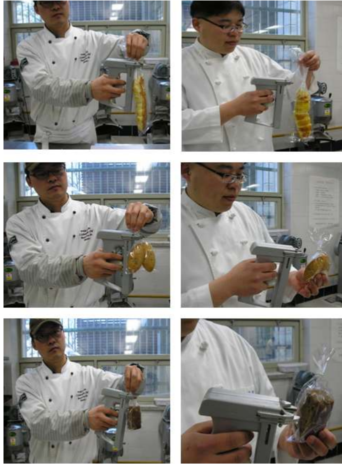
그림 66. 제과제빵 포장봉지의 결속성능 시험-베이커리카페(베이커리 경희)
