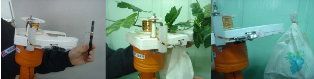
그림 7. 휴대용 포도자동결속장치 시험용 시작기를 이용한 포도보호봉지 결속작업 모습
