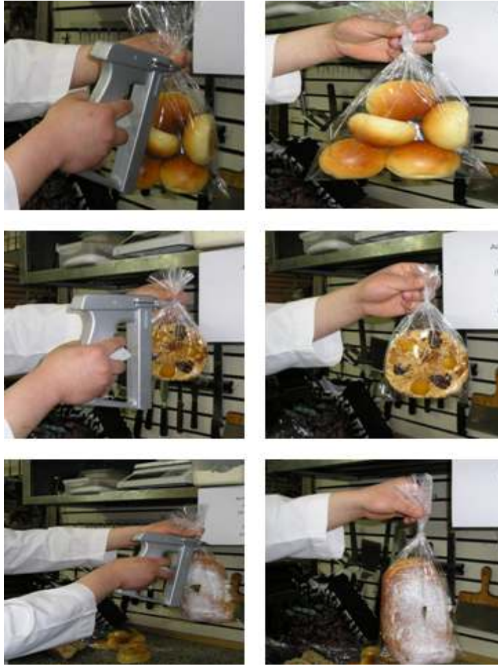
그림 64. 제과제빵 포장봉지의 결속성능 시험-윈도우베이커리(쉐프의 꿈)
