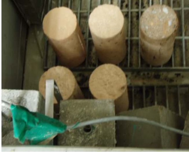
<그림 3.2.5> 동결융해 시험
