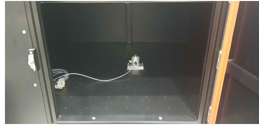
(b) 암실 챔버 내부 인공광원 및 기준센서
