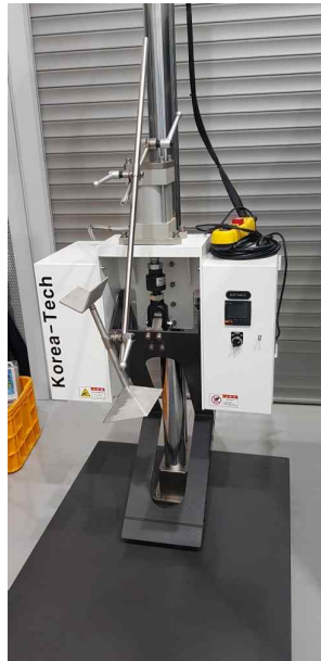
(b) 대형 낙하충격기 (전방) 그림 10. 낙하 충격 시험기
