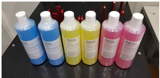
그림 9. 검정용 비커 및 pH 센서 검정용 표준 용액
