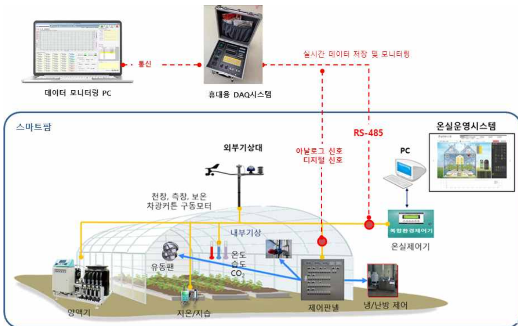
그림 21. 이동형 통합 검인증 시스템 작동 계략도
