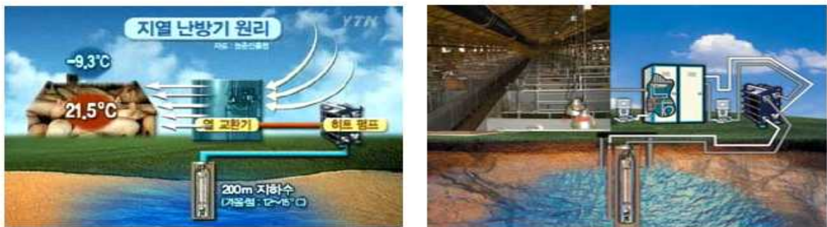
그림 2. 지열 냉·난방 원리 및 설치 모식도
