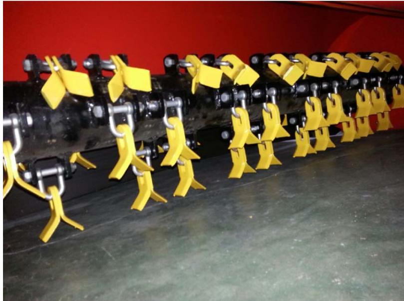
(그림 7-3) 수초제거용 칼날 시작품(제조폭 1000 mm)
