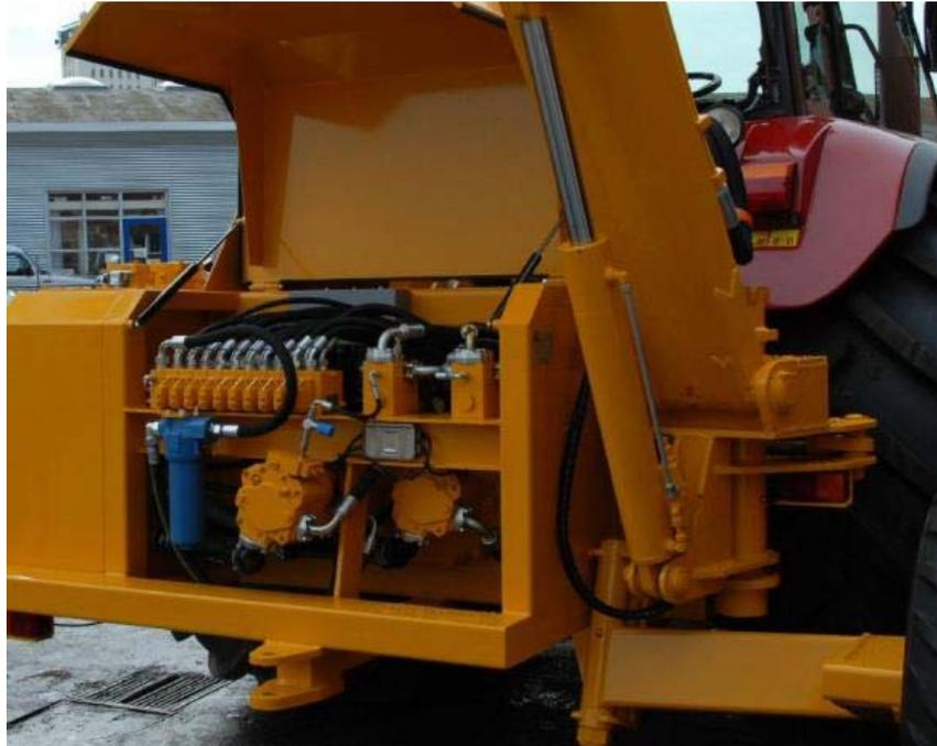
(그림 3-3-15) 100마력급 수초제거용 유압밸브 조립체(7way electric hydraulic control valve)
