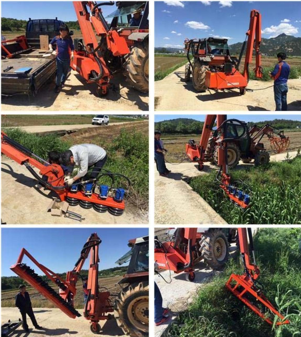
(그림 3-4-3) 제초기 트랙터 설치
