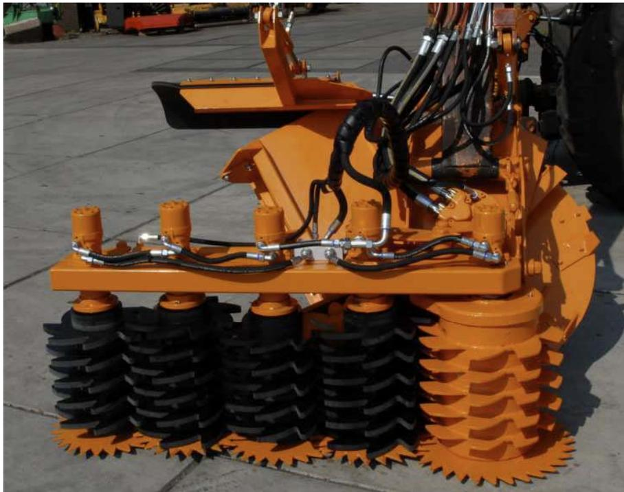
(그림 3-3-11) 100마력급 수초제거용 설계안 II 및 시작품(수초제거폭 1,800 mm)
