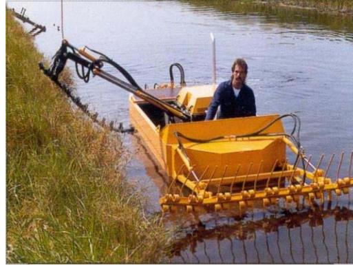
(그림 1-6) Small mowing boat type
