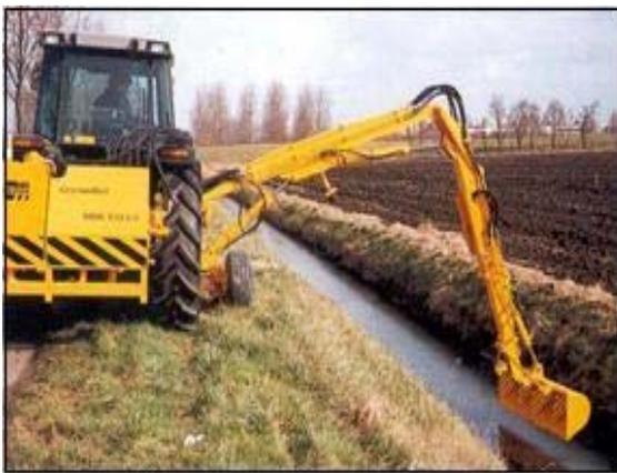
(그림 3-3-1) Mowing bucket type
