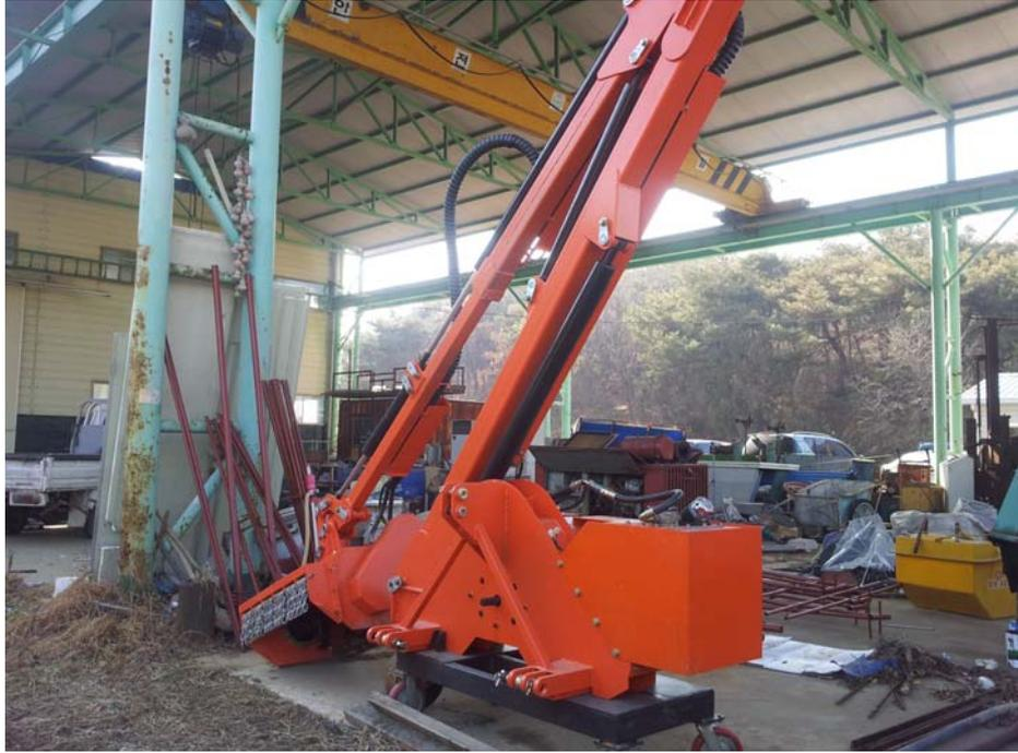
(그림 3-3-45) 대형수로 트랙터용 제초부 개선(봄 및 암 연결 전경)
