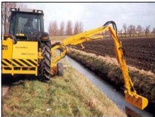
(그림 1-3) Mowing bucket type
