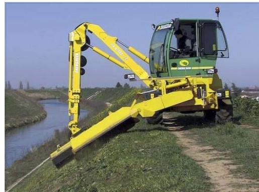
(그림 1-4) Frail mower type
