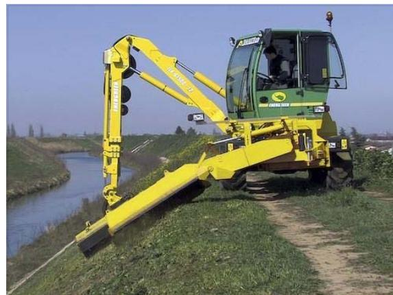
(그림 3-3-2) Frail mower type
