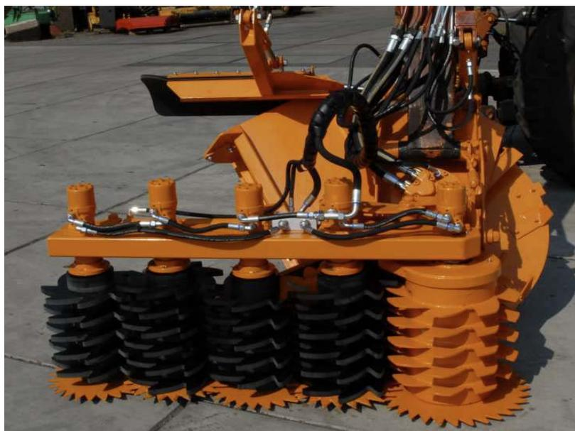
(그림 7-4) 수초제거용 칼날 시작품(제조폭 1800 mm)
