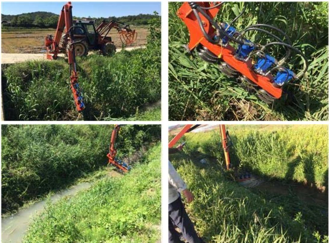
(그림 3-4-5) 원판칼날 병립형 수중 제초부 시험
