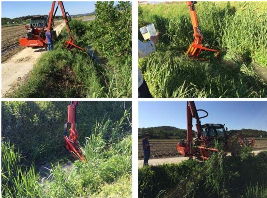
(그림 3-4-6) 삼각칼날 왕복형 수중 제초부 시험
