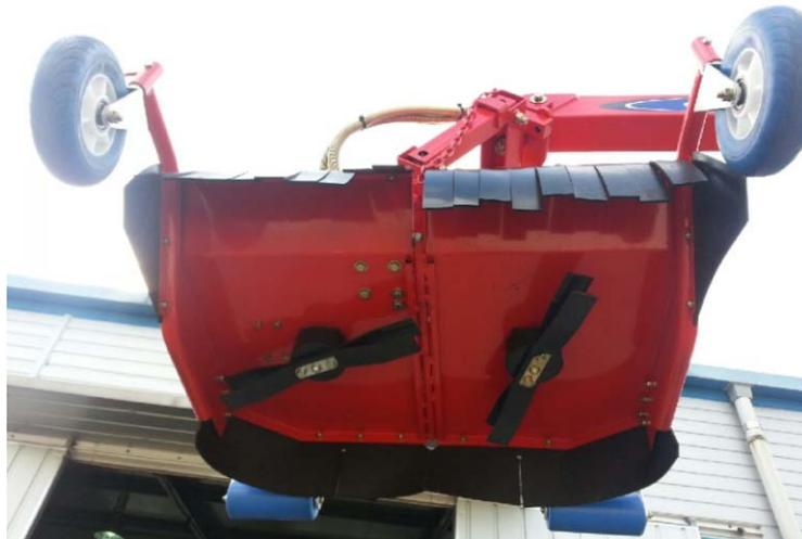
(그림 7-2) 수초제거용 예취날 시작품(제조폭 900 mm, SUP9재질, 중량 59kg)
