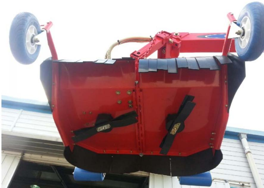
(그림 3-3-9) 수초제거용 예취날 시작품(제초폭 900 mm, SUP9재질, 중량 59kg)
