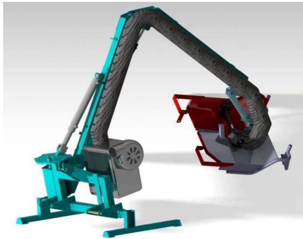
(그림 3-3-6) 50마력 트랙터형 수로 붐 제조장치(제조 폭 ~2.5미터)
