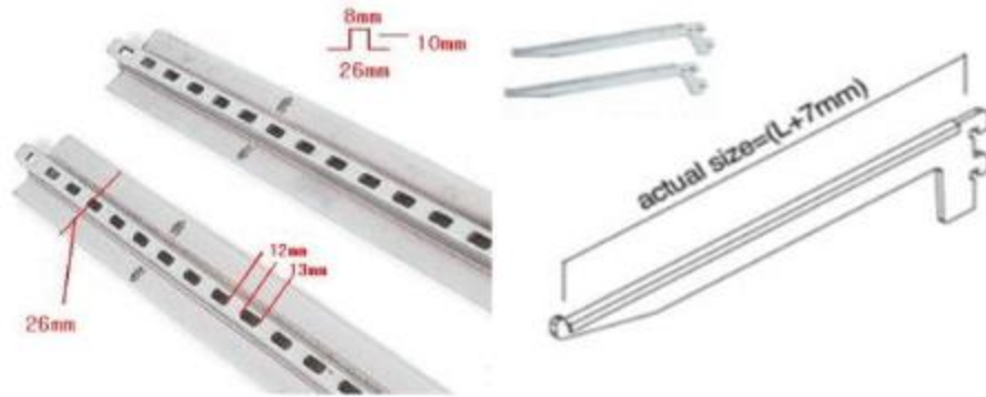
Fig. 134. 선반찬널 및 선반받침대 이미지 및 도면
