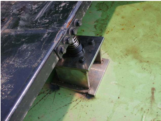
(A) SHOCK ABSORBER 부착에 따른 복원력 점검
