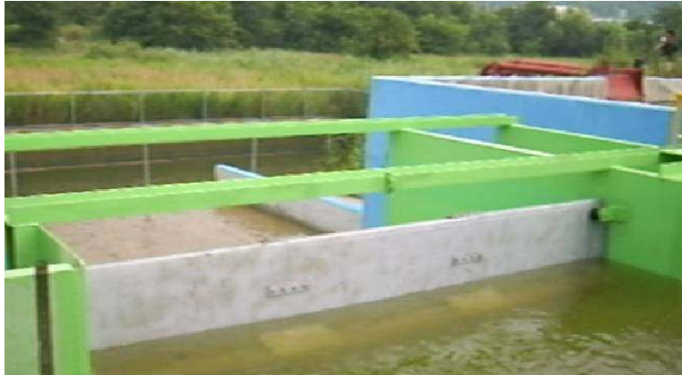
(A) 2차 시작품 작동성 테스트(수위 증가시작)
