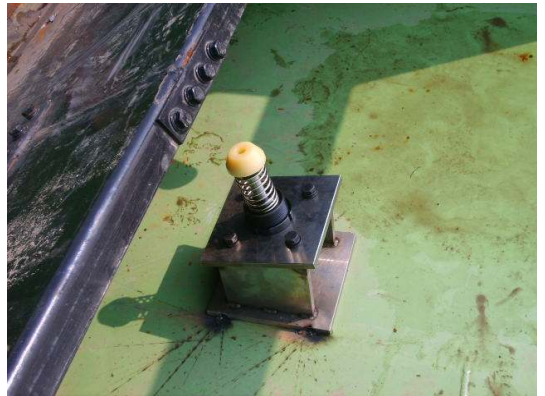
(A) SHOCK ABSORBER 부착에 따른 복원력 점검
