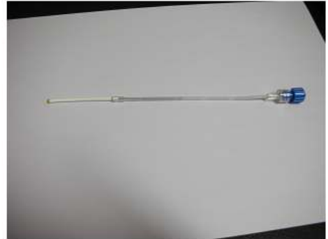
토양 수분 채취기(Rhizon soil moisture sampler, Eijkelkamp)
