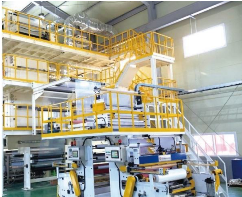
그림 69 5Layer (5층) 압출기를 갖춘 연구용 생산시설비
