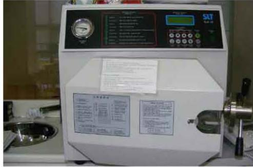
그림 2-100. Ethylene oxide (EO) gas sterilizer
