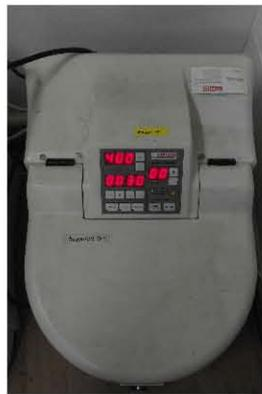
그림 2-98. Planetary Mono Mill PULVERISETTE 6 classic line(독일, Fritsch)
