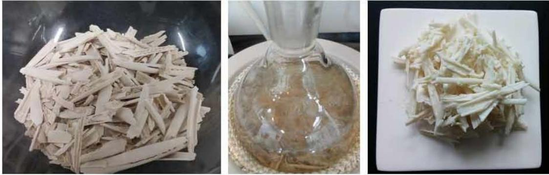
그림 1-92. 열처리 후 hydrogen peroxide 처리 및 유기 탄화물 완전 제거 (공정 3).
