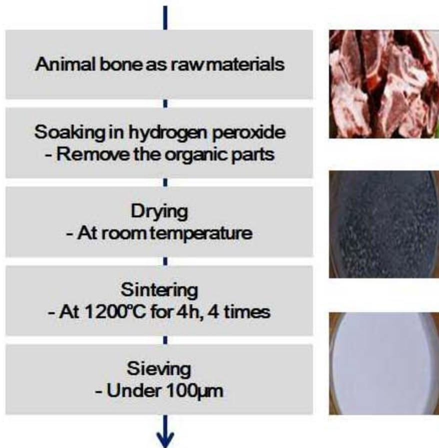
그림 2-1. 말뚝을 이용한 골대체제 생체소제의 제조 공정 모식도.
