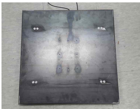
그림 124 무게 센서 시제품 제작
