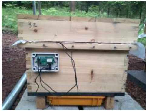
그림 52 센서 노드 외벽 설치
