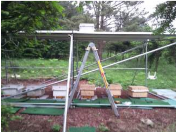
그림 32 태양광 모듈 설치 모습 (외부보호함 덮개에 설치)
