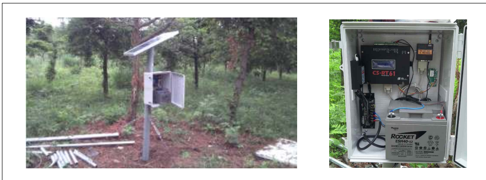
그림 152 데이터 수집 전송 시스템 전체(좌) 및 내부(우) 모습
