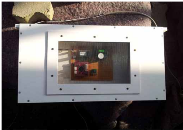
그림 197 제 3차 Sensor 디바이스. 격리망에 밀랍이나 프로폴리스를 도포하지 않았다.
