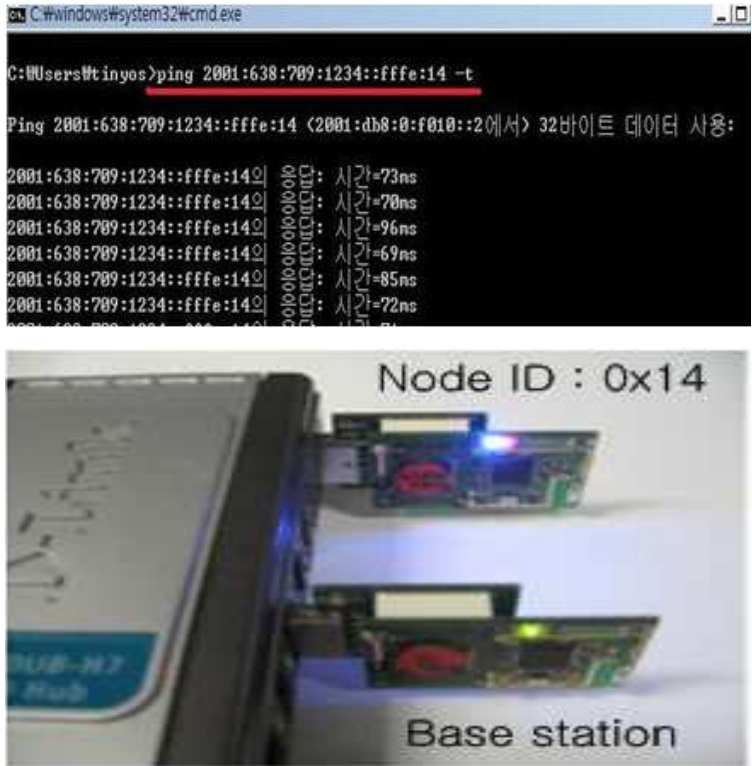
그림 175 6LowPAN 환경에서의 ping 테스트
