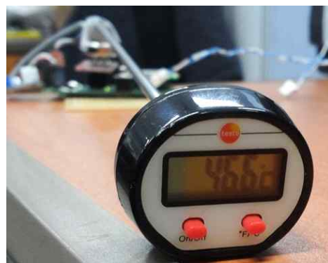
그림 100 MG811 CO2센서의 발열측정
