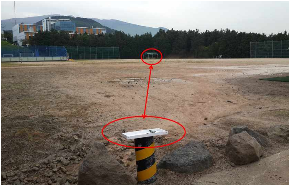
그림 189 Zigbee RF 송수신 테스트 사진
