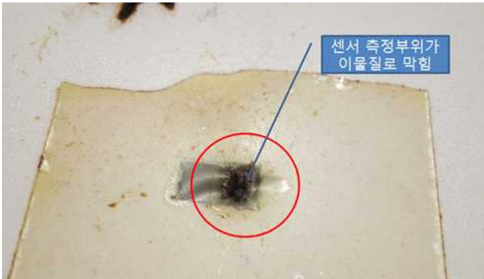
그림 93 센서 측정부위 막힘
