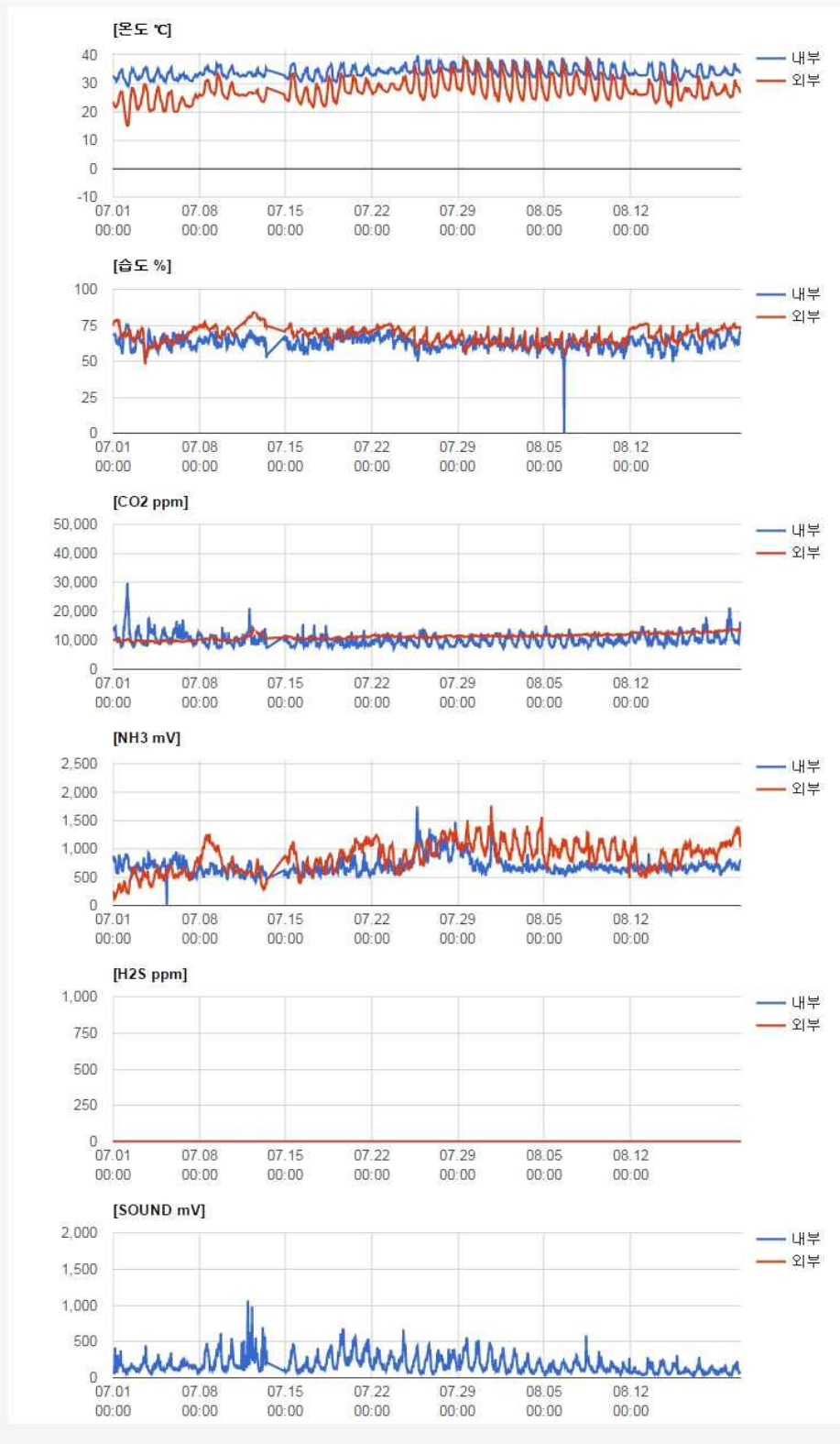
그림 268 흡서기 (7월 23일 - 8월 11일) 직사광선에 일 중 노출된 봉군의 센서 신호값
