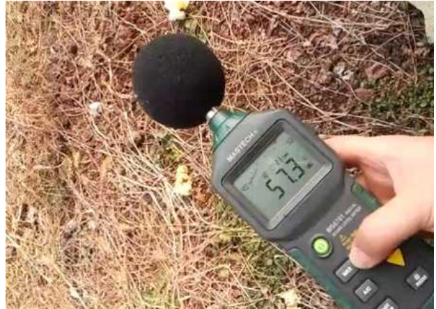
그림 114 꿀벌통 주변 2M 거리의 소음도 측정
