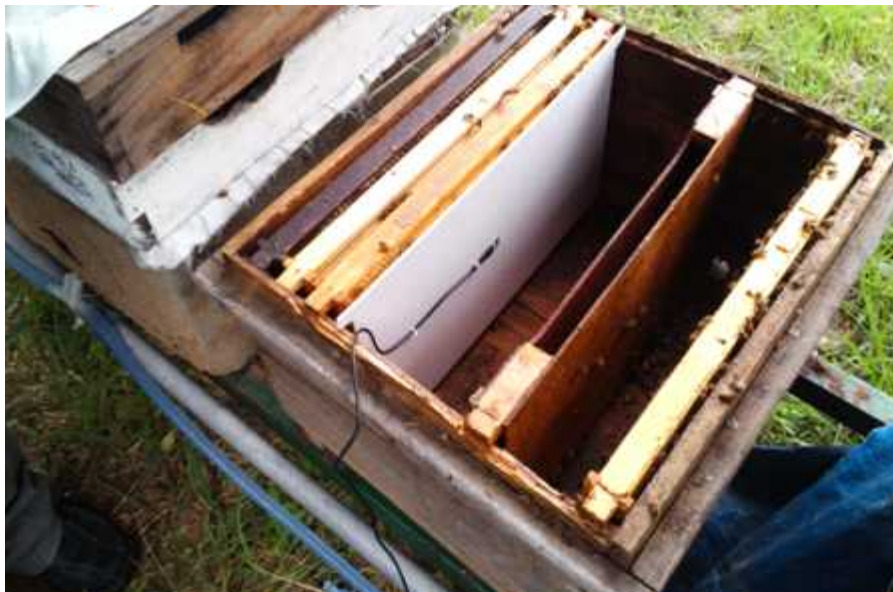
그림 92 CHIPCAP-L/Module 온습도 센서 실환경 설치 테스트
