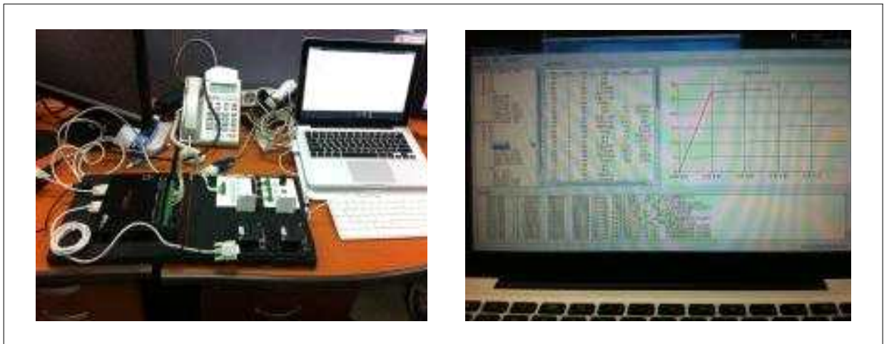
그림 10 데이터 로거와 게이트웨이 연결 모습 및 USN 미들웨어 시험화면
