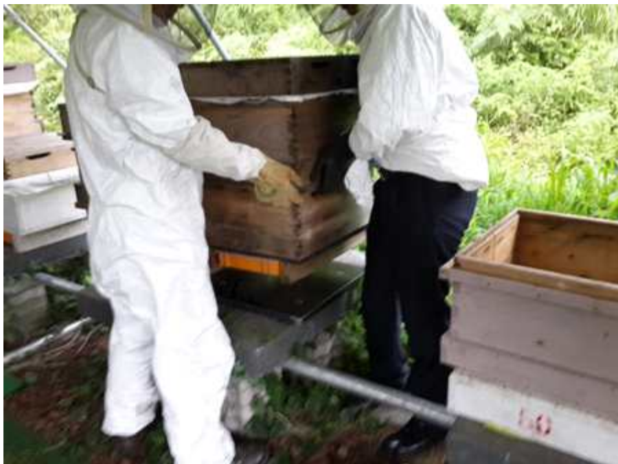
그림 401 무게센서 포함형 설치
