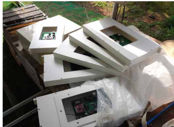
그림 198 제 4차 Sensor 디바이스. 제 3차 디바이스에 비하여 브라켓 외부로 돌출된 부분을 제거하여 꿀벌 소비건축, 통행에 미치는 영향을 최소화하였다.
