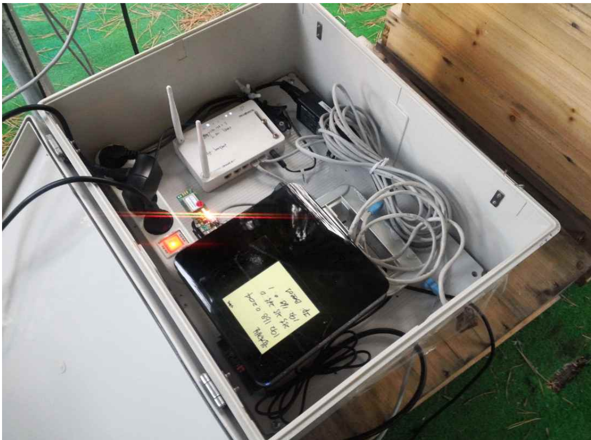
그림 115 소형 PC를 이용한 게이트웨이 설치
