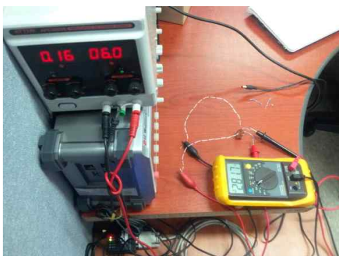
그림 99 MG811 CO2센서 소비전력 측정
