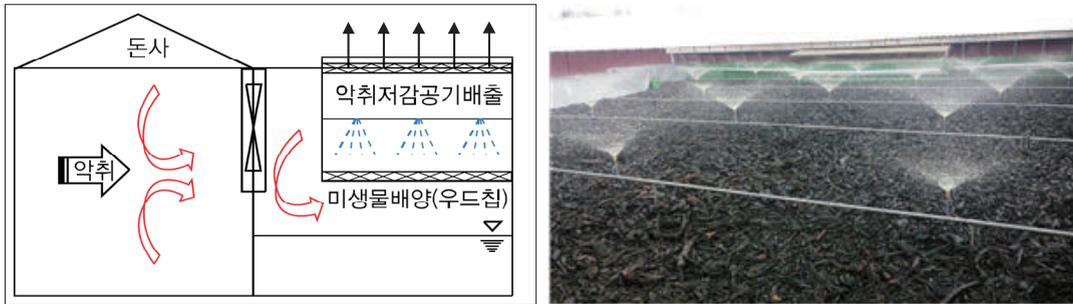
그림 37 물리와 화학과 생물학적 방법을 이용한 복합악취 제어
