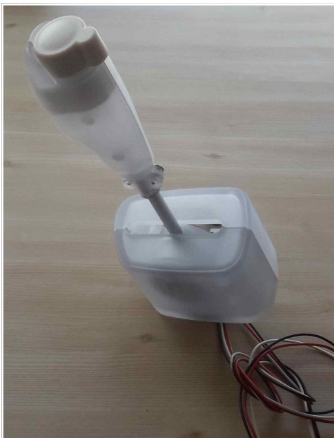
그림 3.1.53 무단변속기 전용 변속 레버의 시제품(좌)과 실제 트랙터에 적용된 변속 레버(우)
