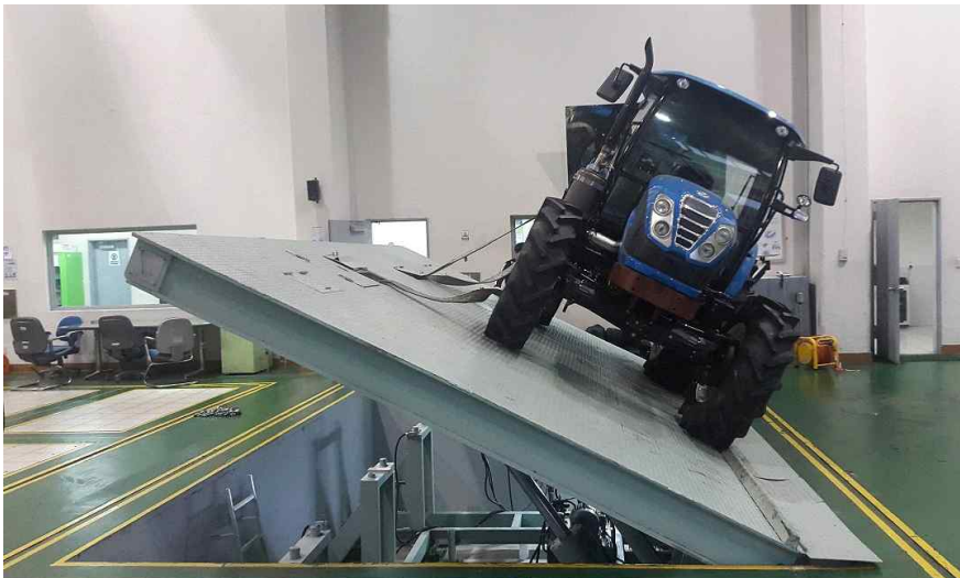
그림 3.4.61 횡전도각 측정 시험
