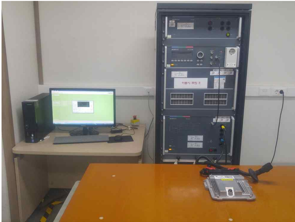
그림 3.4.49 전압 변동 내성 시험 사진
