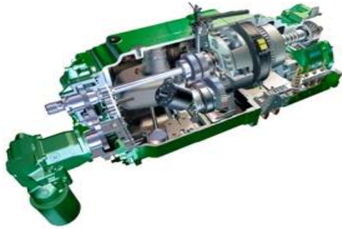
그림 1.2.2 John Deere 社 IVT (HMT 방식)
