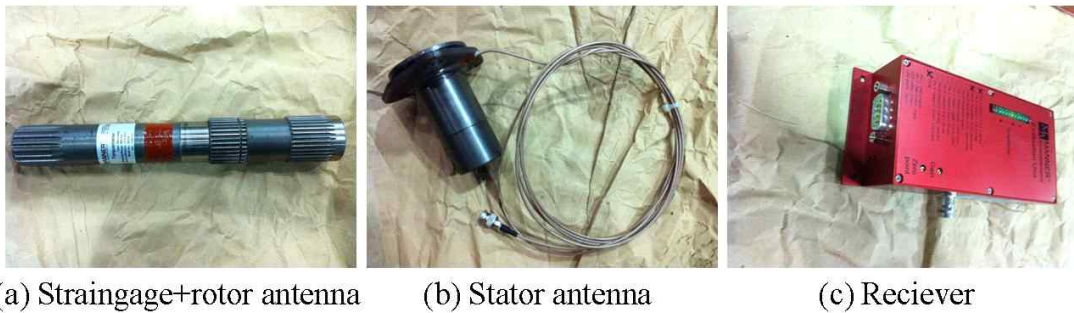
그림 3.2.62 Components of torque measurement system for transmission input shaft.
