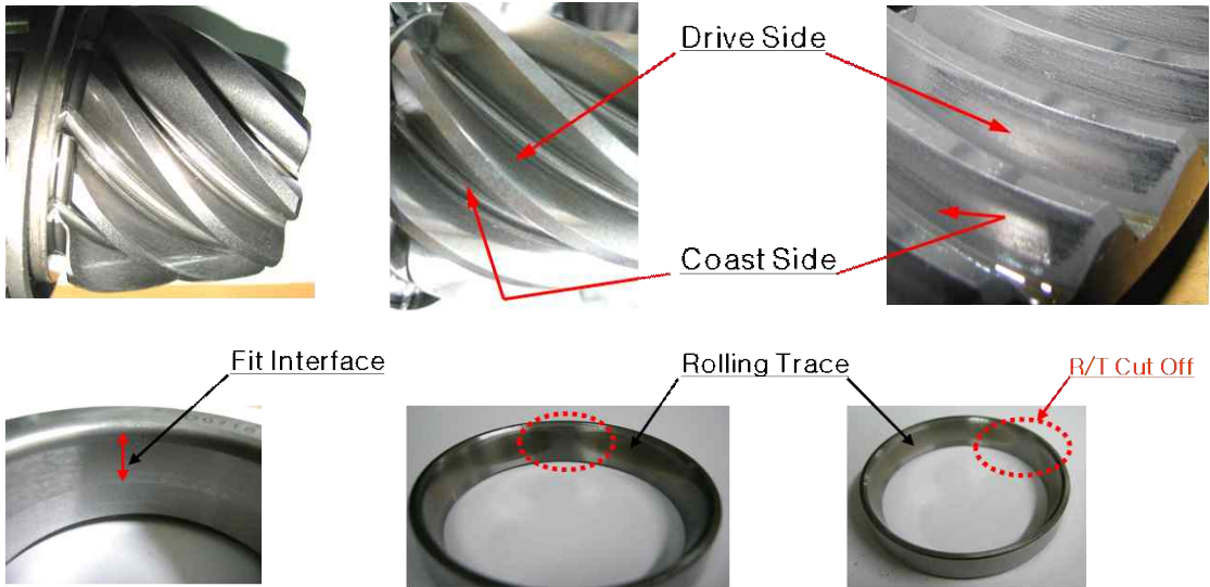
그림 3.4.46 피니언기어 & 테이퍼롤러베어링 3차 시험결과
