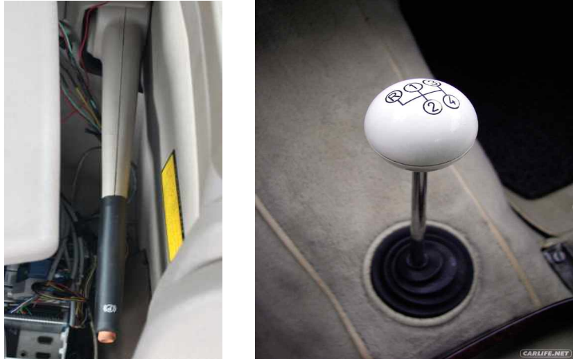
그림 3.1.46 말단부의 측면을 감싸쥐는 레버 (좌) 말단부의 상단을 감싸쥐는 레버 (우)
