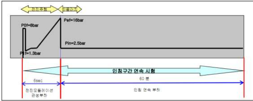
그림 3.4.23 클러치 소착시험 사이클
