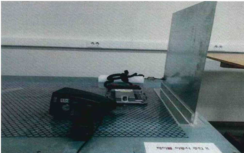
그림 3.4.48 정전기 방전 내성 시험 사진
