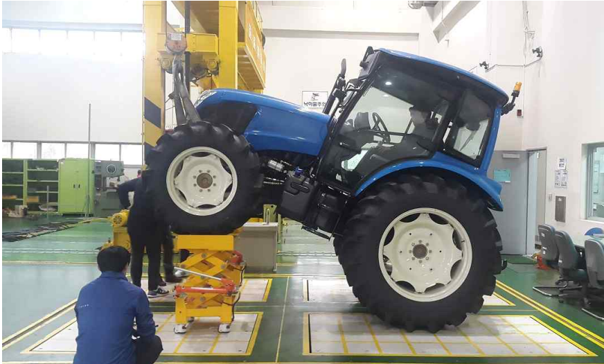
그림 3.4.60 중심 위치 측정 시험
