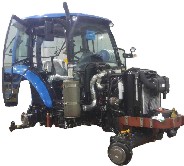
그림 3.1.55 엔진 시동 및 유압 제어 기능 검증을 위한 조립 상태
