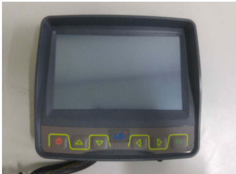
그림 3.1.50 디스플레이 2차 시작품 (LCD 모니터)
