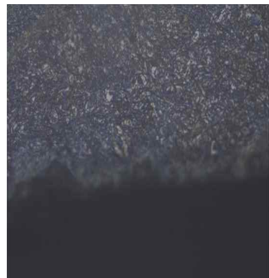
그림 3.4.47 열처리 검사성적서 & 표면(좌)/심부(우) 500배 확대 사진
