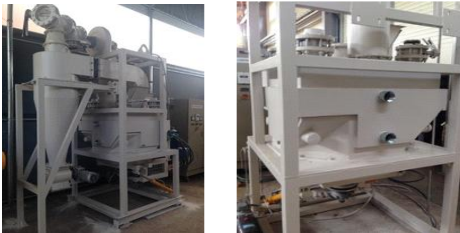
Fig. 3-7. 수확후 열 회수형 건조기와 Jacket 장착 (Dryer with Jacket with waste heat)
