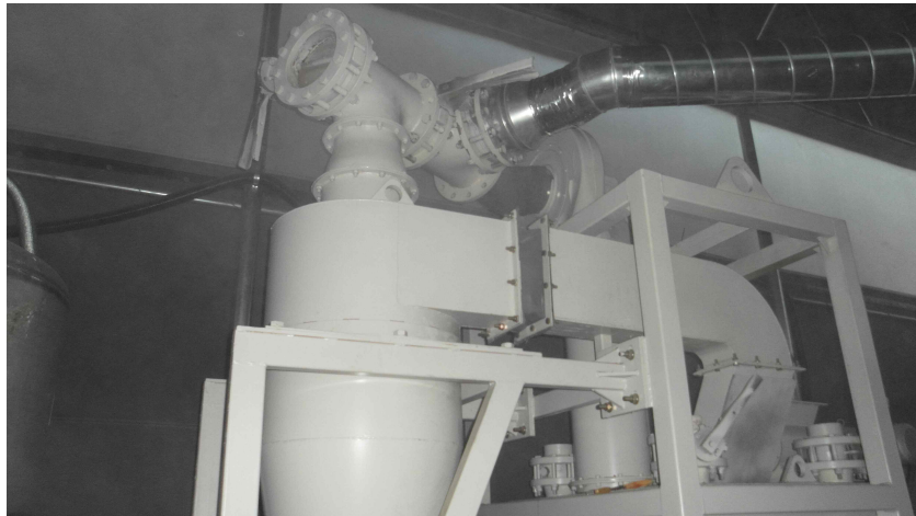
Fig. 3-5. 수확후 열덕트가 연결된 기류식 건조기 (Dryer with duct of waste heat)
