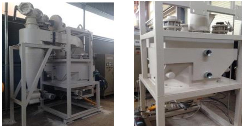
Fig. 3-9. 기류식 건조기에 수확후열활용 (Dryer with waste heat)
