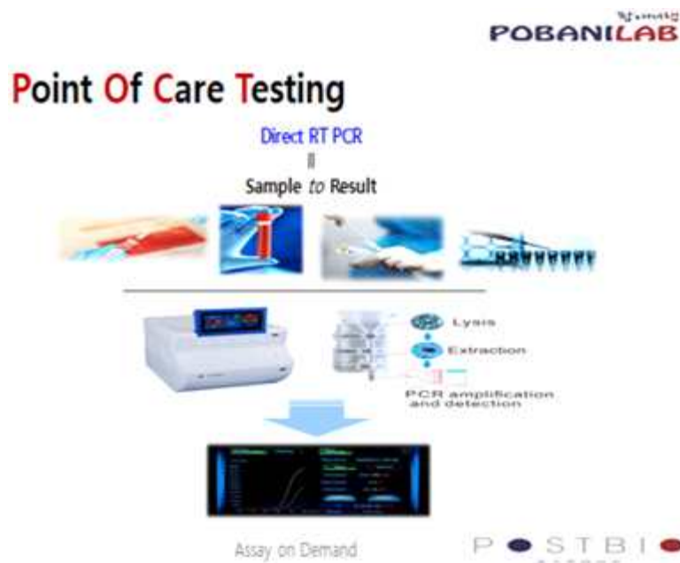
< 포스트바이오가 개발중인 현장용 분자진단키트의 작동원리 및 개념모식도 >
