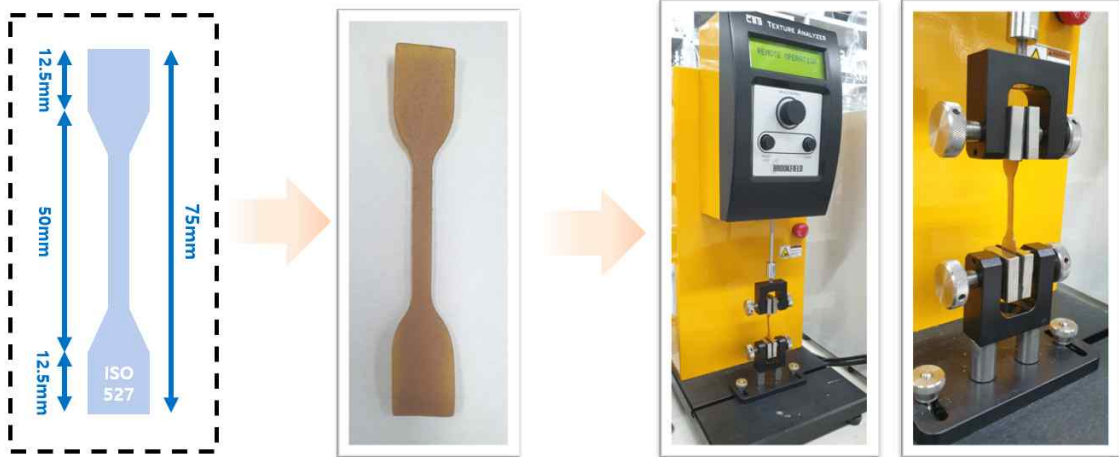
그림 4. 인장 능력 · 파단 연신율 측정 규격(ISO-527) 및 CT3 Texture analyzer.
