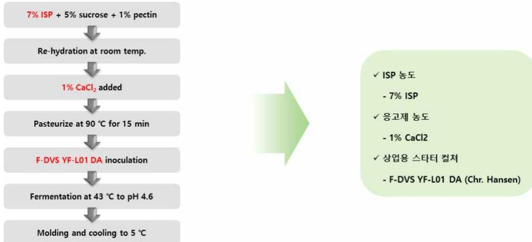
그림C-2. 상업용 스타터 컬처를 이용한 식물성 치즈의 최종 제조 공정
