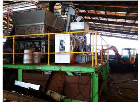
<5루베급 탈수기계 시스템 설치사진>
