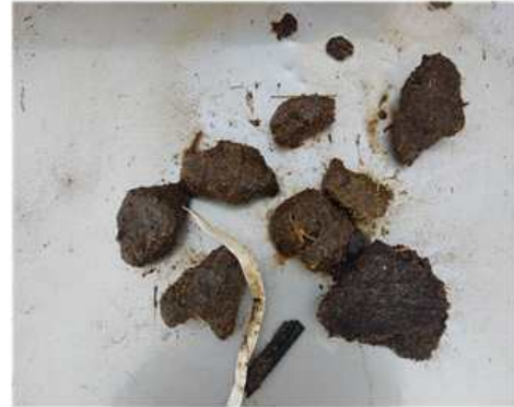
그림 49. 탈수시험 중 이물질 확인
