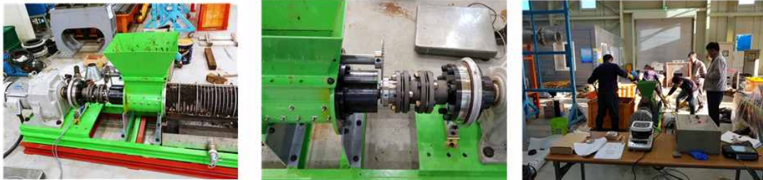
(a) 기어드모터를 장착한 탈수기계 (b) 기어드모터와 연결된 커플링 및 토크센서 (c) 탈수기계 시험장면
