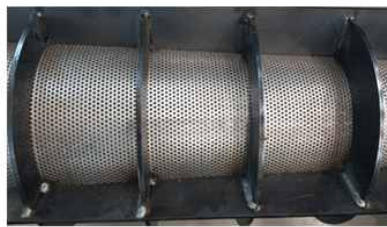
(b) 직경 \varnothing 2 mm 타공망
