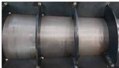
(a) 직경 \varnothing 1 mm 타공망
