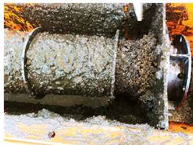
(b) 기존 타공망으로 탈수 후 찌꺼기가 있는 상태
