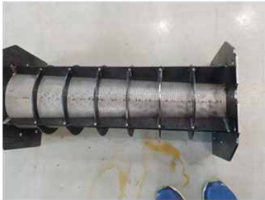
(a) 타공망 제작 후 조립전 상태
