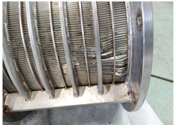
<시험평가 후 작은 이물질 투입되어 스크린 파손_외부상태>
