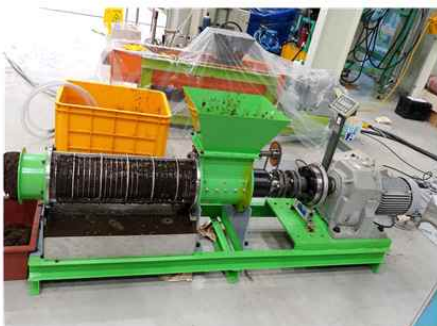
(a) 기존 탈수기계 하부프레임 상태 (탈수시험시 변형발생)
