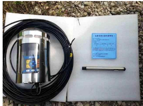
(b) 센서, RTU, 전원공급장치, 케이블 준비
