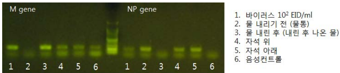
그림 11. 10^2 EID/ml을 물통에 넣었을 때 유전물질 농축/정제/검출기술 평가 결과(RNA extraction kit로 유전자 정제)
