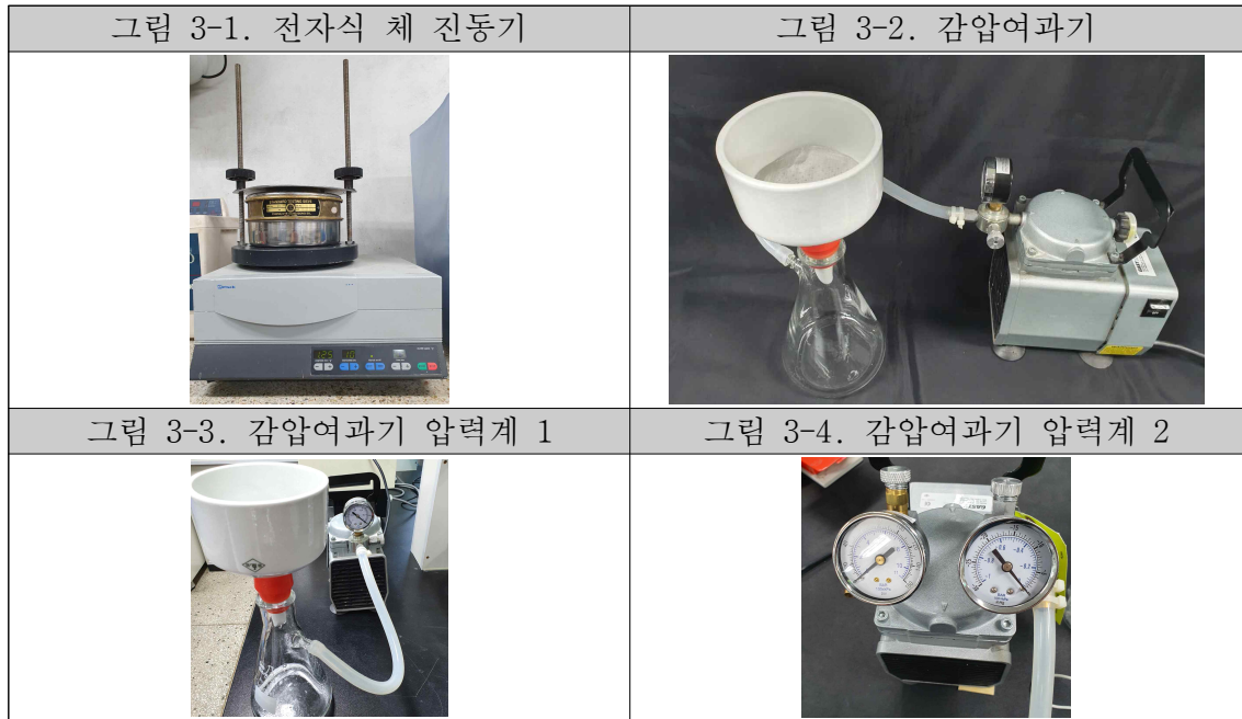
그림 3. 전자식 체 진동기 및 감압여과기 장치 사진
