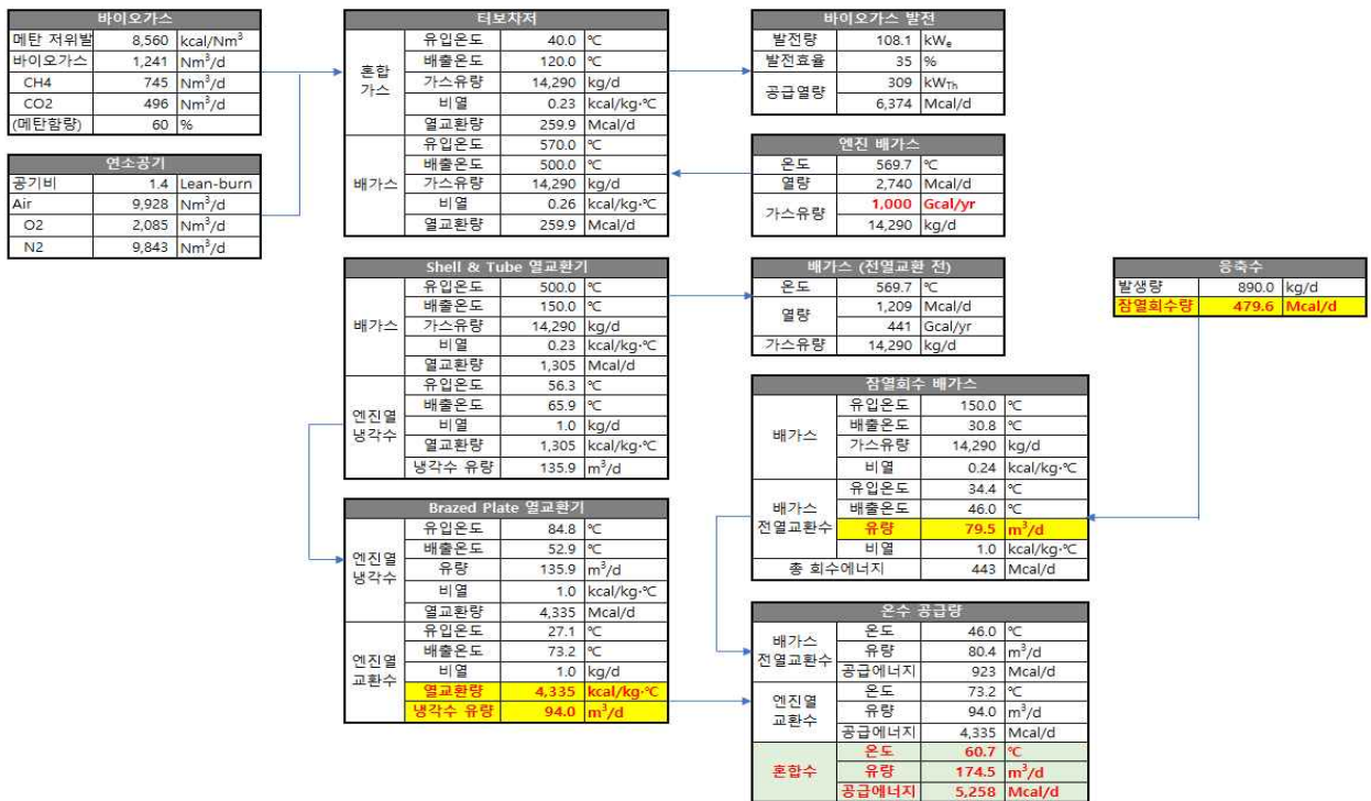
그림 55. 바이오가스 발전 폐열 회수 시나리오(Case 2)에 따른 상세 물질·에너지 수지
