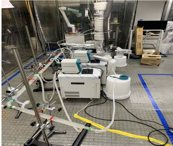
그림 23. 습식 세정탑형 전열교환기 저류조 냉각 및 연속운전을 위한 시스템 구성
