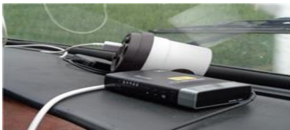
[축산차량 GPS 단말기 설치]
