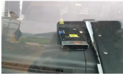
[축산차량 GPS 단말기 설치]
