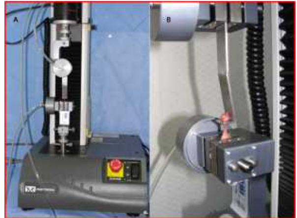
<물성검사> A. Instron 3343, pneumatic grip 및 쥐 근육 고정기구(디자인등록:30-0854878) B: 쥐의 하견갑건에 장력이 가해지고 있음
