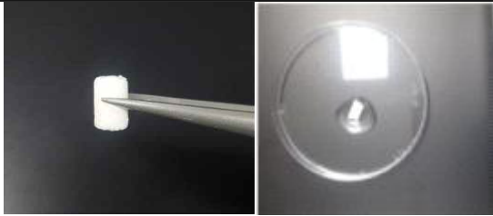
[그림6] 최종 약물 탑재가 가능한 콜라겐+골이식재 시제품
