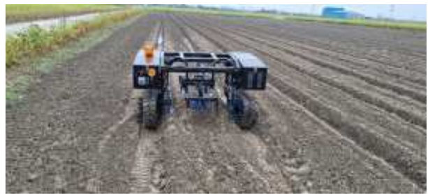
그림 88 두둑성형 규격 및 기체 주행성능 검토
