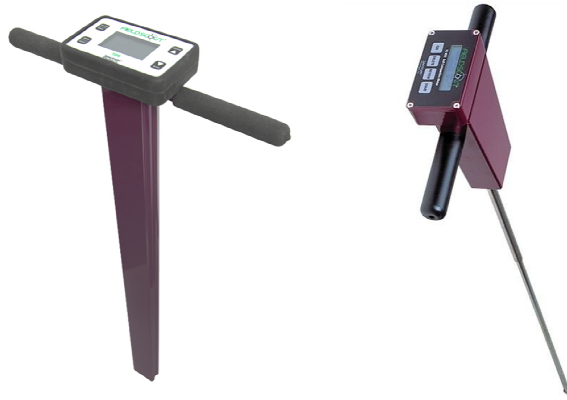
그림 206. 토성 측정 장비(좌: TDR 500, 우: SC 900)
