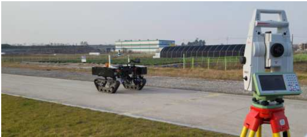
그림 146 자율주행 중인 제초 로봇과 광파 거리 측정기
