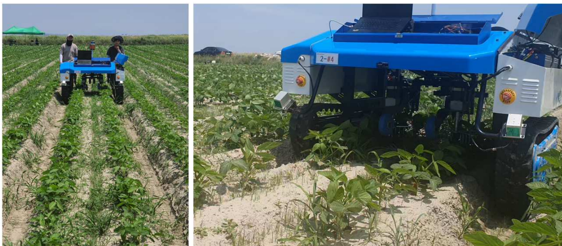
그림 169 두둑을 검출하는 제조 로봇
