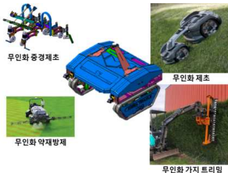
그림 44 무인화 주행기체의 작업기 탈착구조에 의한 범용 활용성 확보
