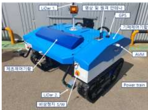
그림 79 자율주행 및 제초제어 센서장착
