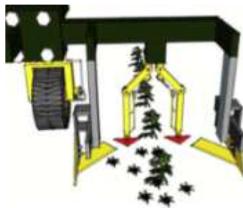
그림 41 영상정보에 의한 능동형 주간제초
