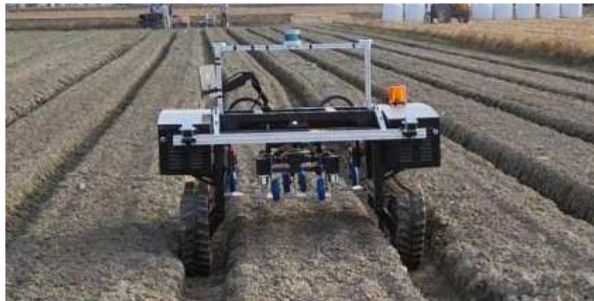
그림 152 발의 두둑을 따라 이동 중인 제초 로봇
