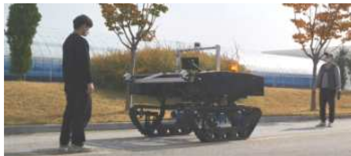
그림 124 전방 물체를 감지하고 정지한 제초 로봇
