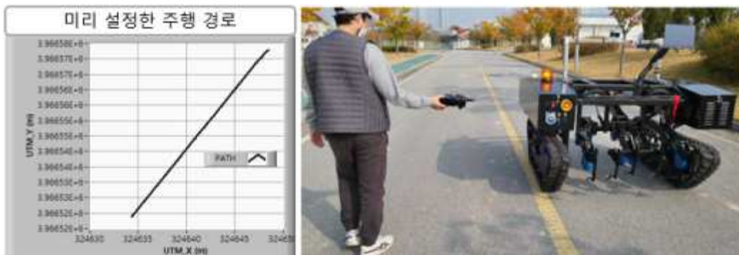
그림 149 미리 설정한 주행 경로를 추종하는 제초 로봇
